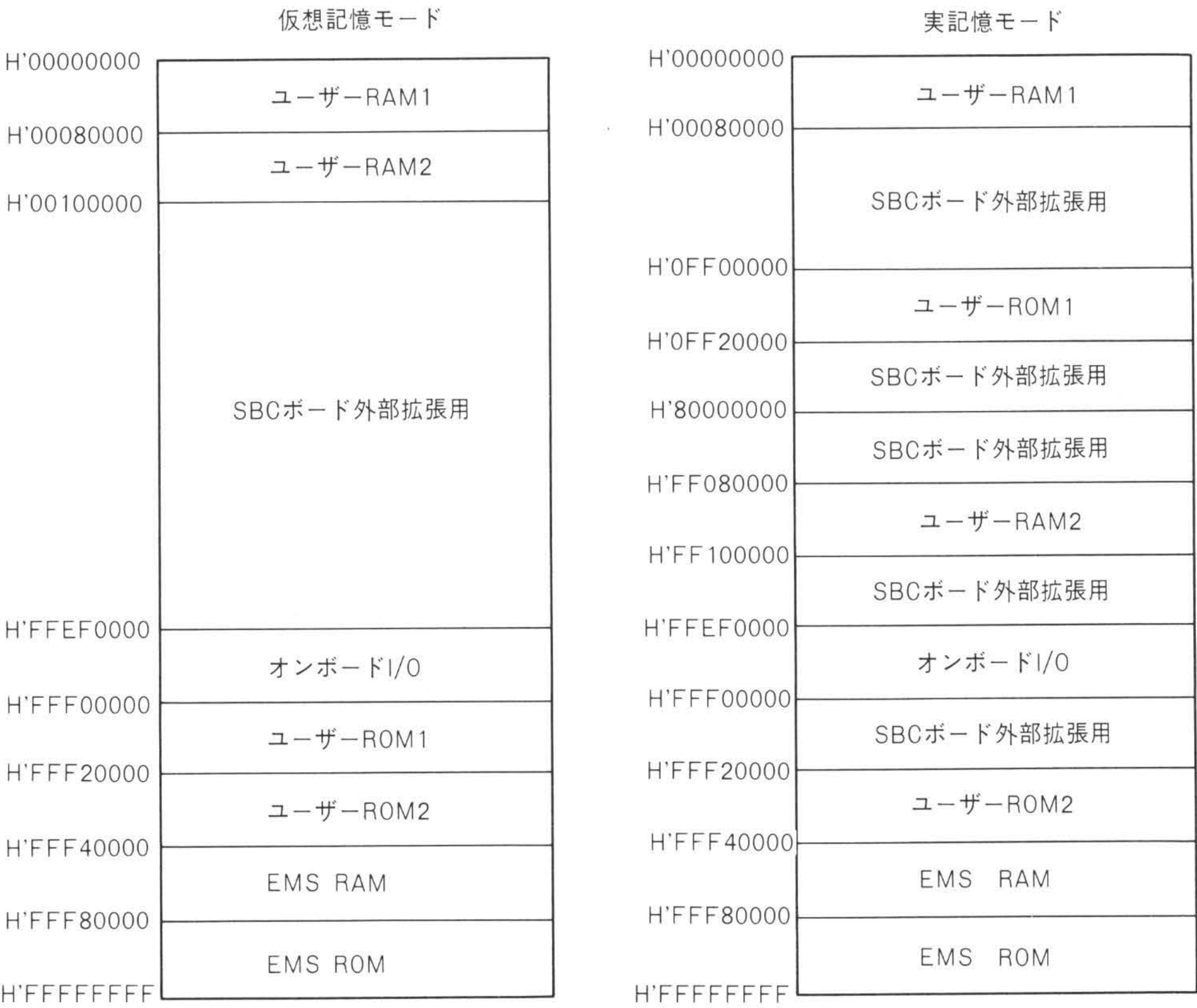
図4 H32SBCのメモリマップ H32SBCの持つ二つのメモリマップを示す。メモリマップの切換えはスイッチで行う。
