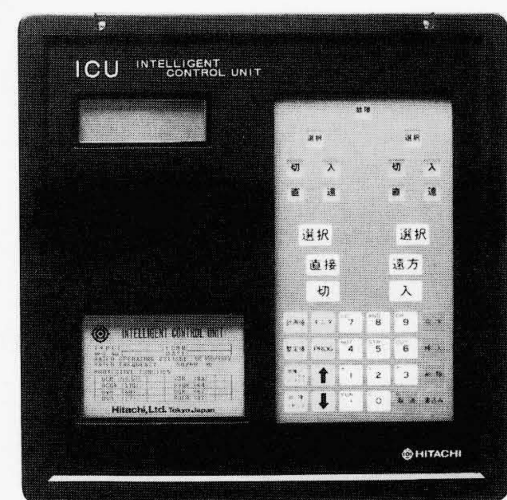
図12 ICU外観図 左側は液晶表示部、右側はシートキーによる操作・設定部となっている。
