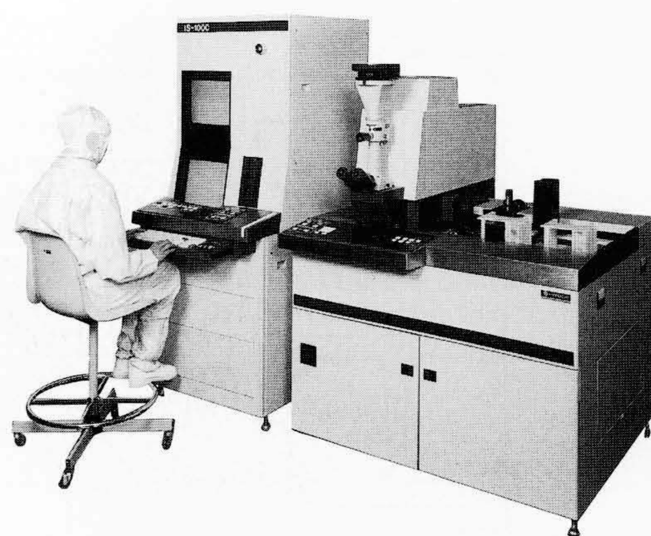
図11 ウェーハ上異物検査装置 パターン付き製品ウェーハ上の1 μm以上の異物を検出できる。検出した異物のウェーハ上の分布をディスプレイに表示する。検出異物を必要に応じて顕微鏡下に自動的に位置決めし、観察できる。
