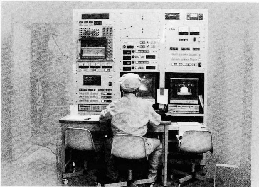
図2 LEC法高圧引上装置 10 MPaに耐えられるチャンバ中に、マルチゾーンヒータから成る加熱炉を持つ。また、マイクロコンピュータにより自動制御で結晶作製ができる。
