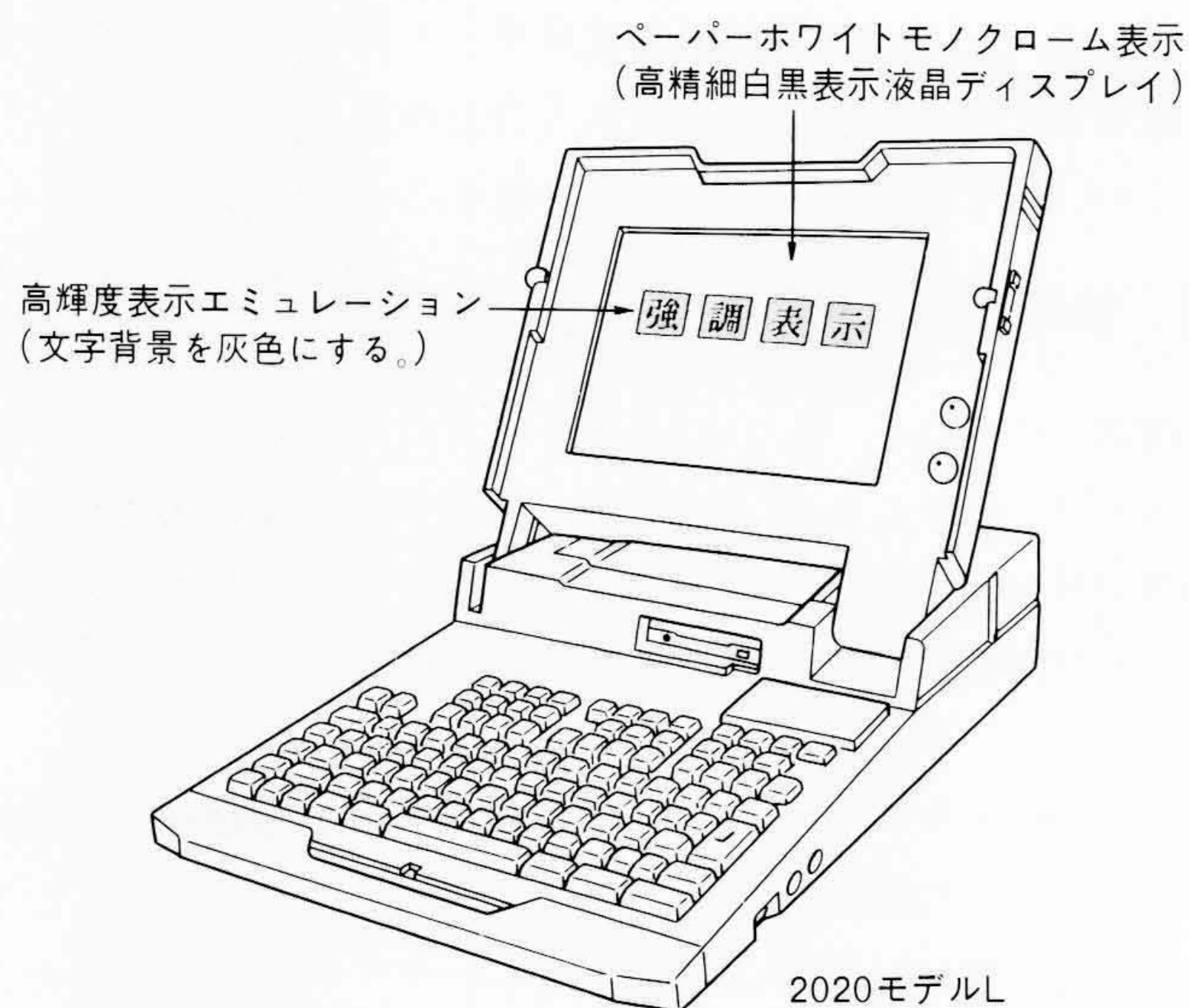
図12 2020モデルLの高輝度表示エミュレーション 高輝度表示指定を、文字背景を灰色とする強調表示機能で、エミュレーションを実現した。
