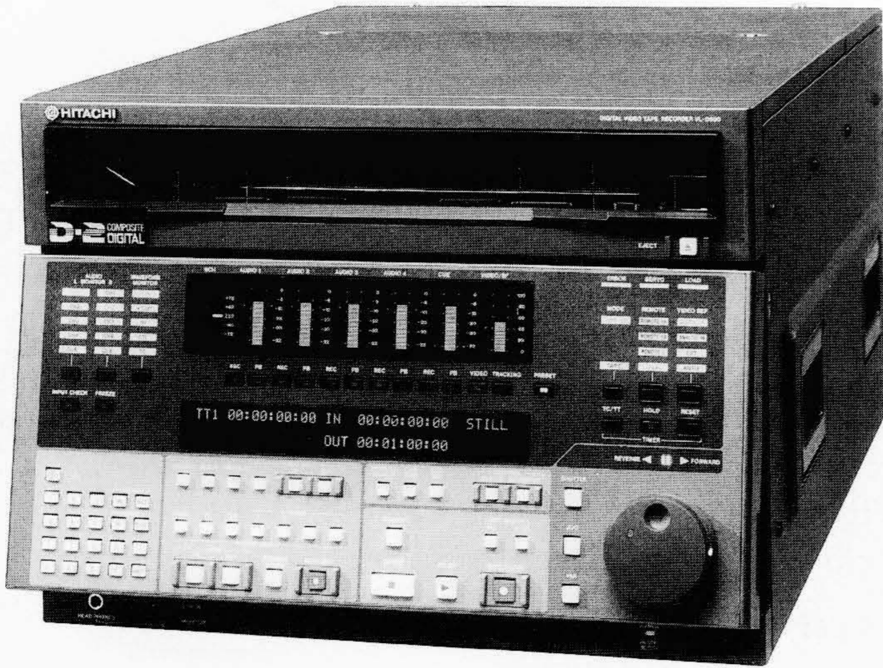
図1 VL-D500の外観 L, M, Sカセット対応で最大208分の高画質、高音質の記録、再生が可能であり、ラックマウントが可能なコンパクトサイズを実現している。
