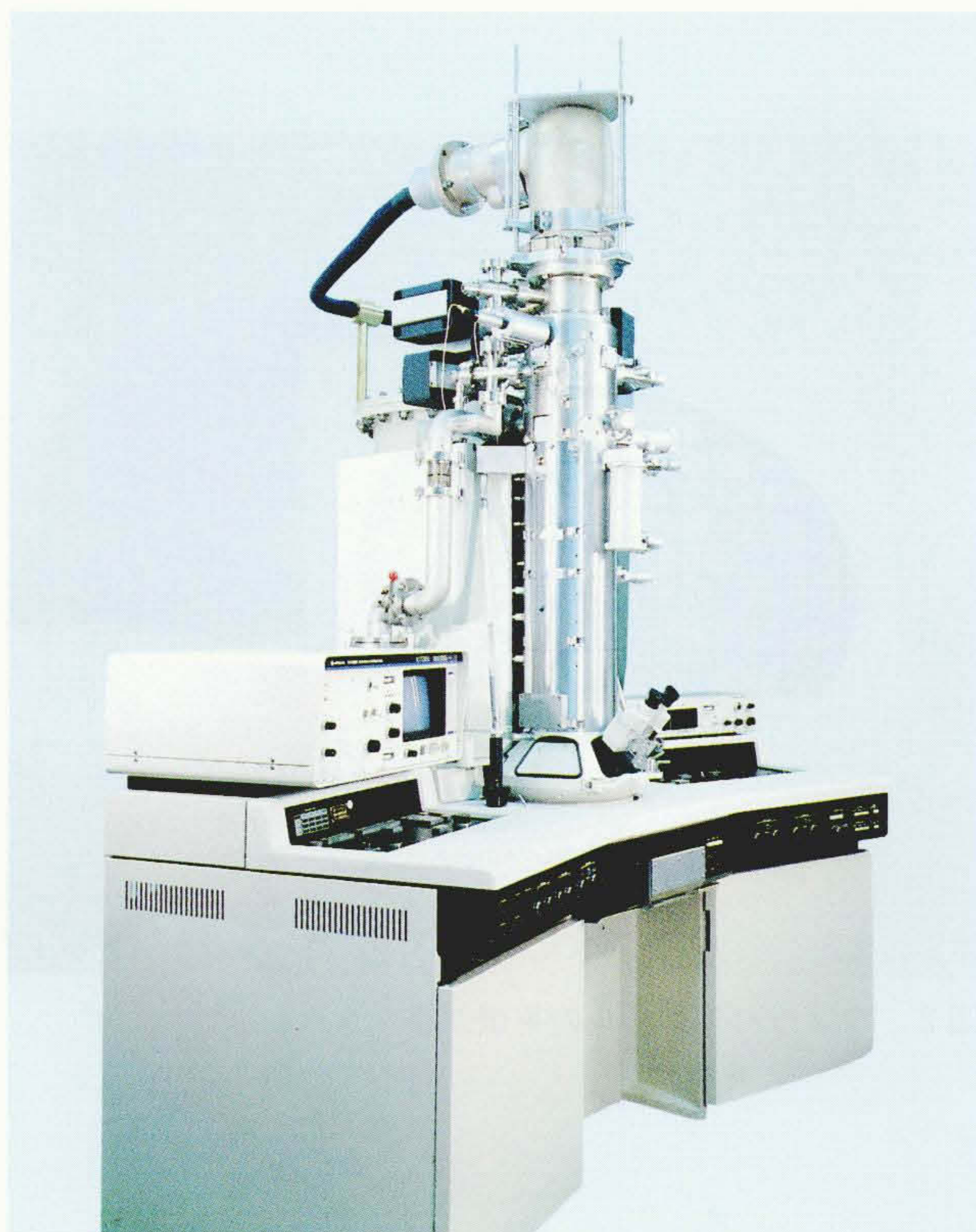
図1 ホログラフィー電子顕微鏡
