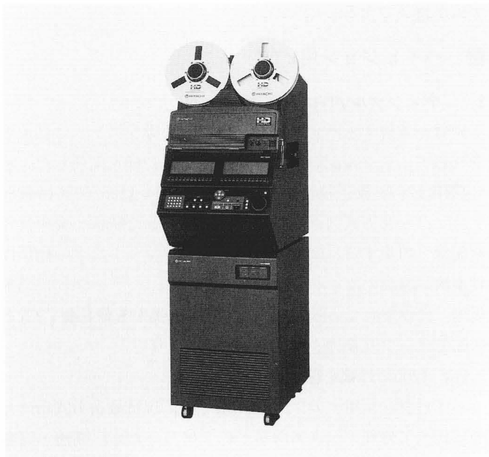
図5 ハイビジョンデジタルVTR HV-I200の外観 テープトランスポート部HV-TI200(上部)とプロセッサ部HV-PI200(下部)とで構成し, 容易に分離または一体化できる。
