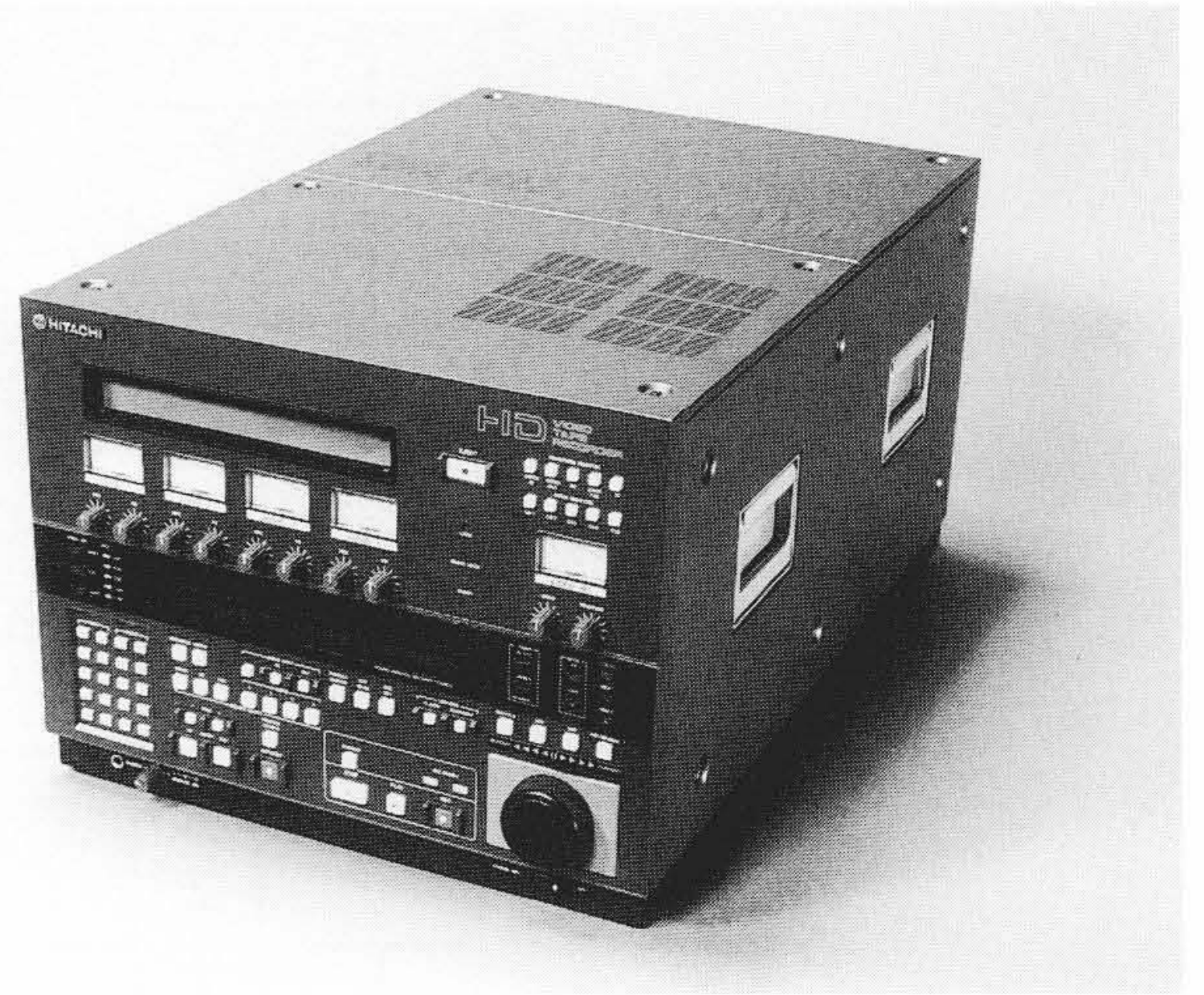
図7 UNIH-VTR本体部の外観 1/2インチ新小形カセットを用いたUNIH-VTRの試作機を示す。
