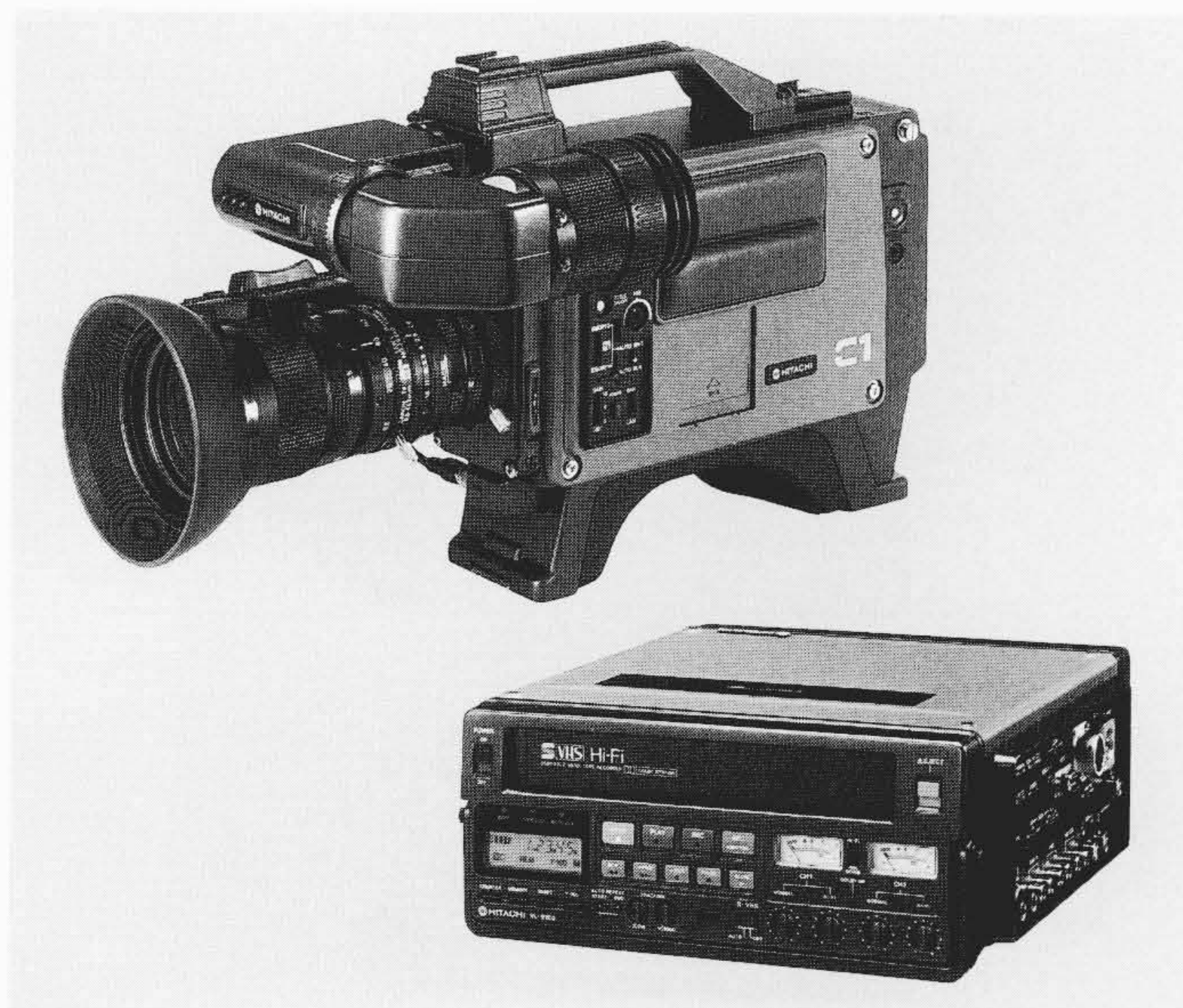
図9 3板式CCDカラーカメラの外観 15倍ズームレンズを搭載したFP-C1ポータブルカラーカメラを示す。右下は日立ポータブルS-VHS VTRである。
