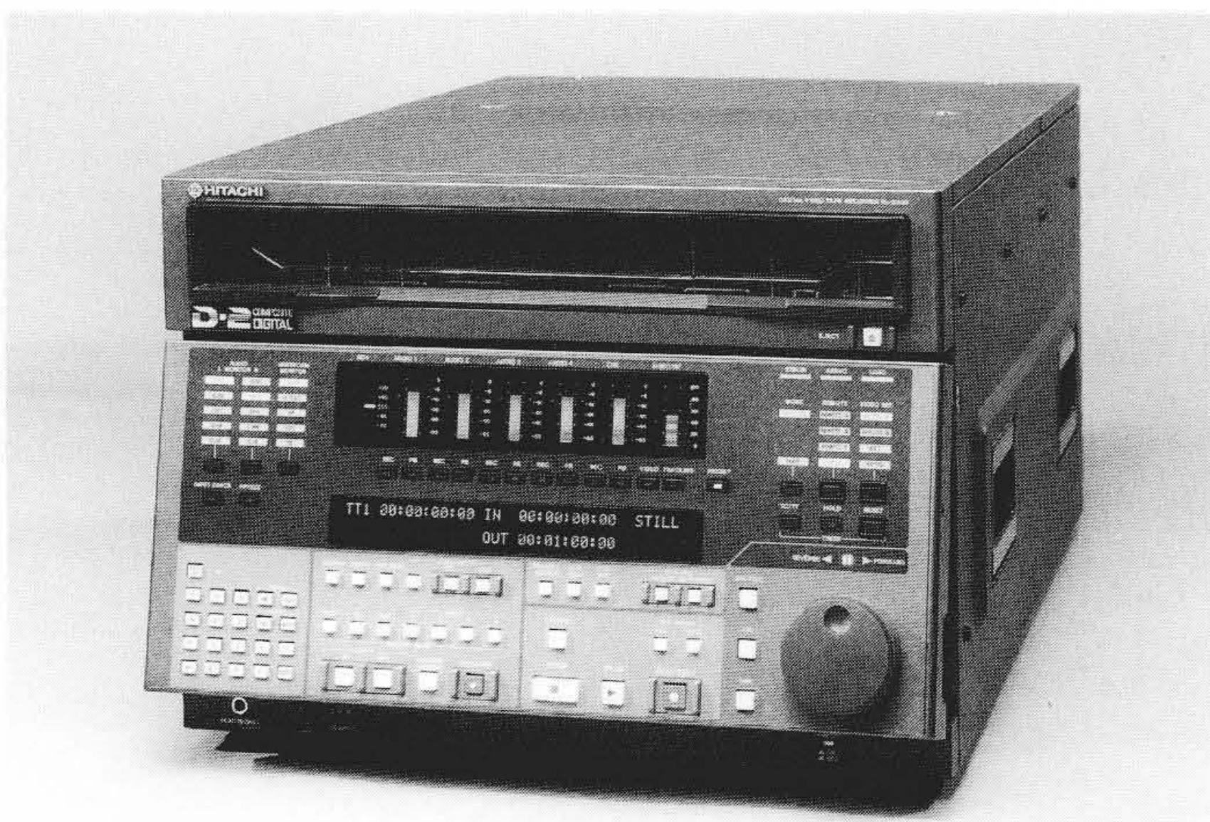
図1 業務用デジタルVTR(VL-D500) 放送局、プロダクション向けに開発した高性能・高画質なVTRで、業界で標準となりつつあるD2フォーマットを採用している。
