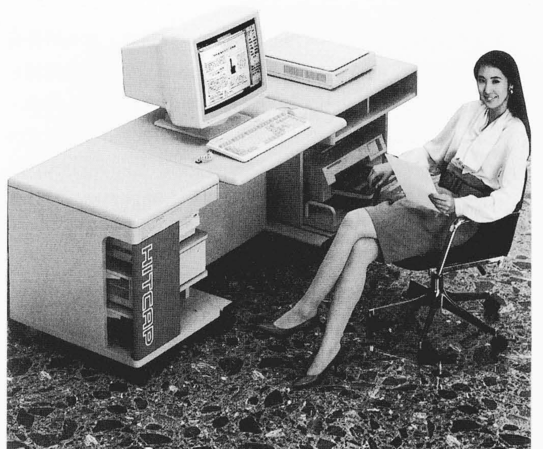
図1 HITCAP500の外観 左側のシステムラック内に、B16HXIIと編集制御装置を収納している。
