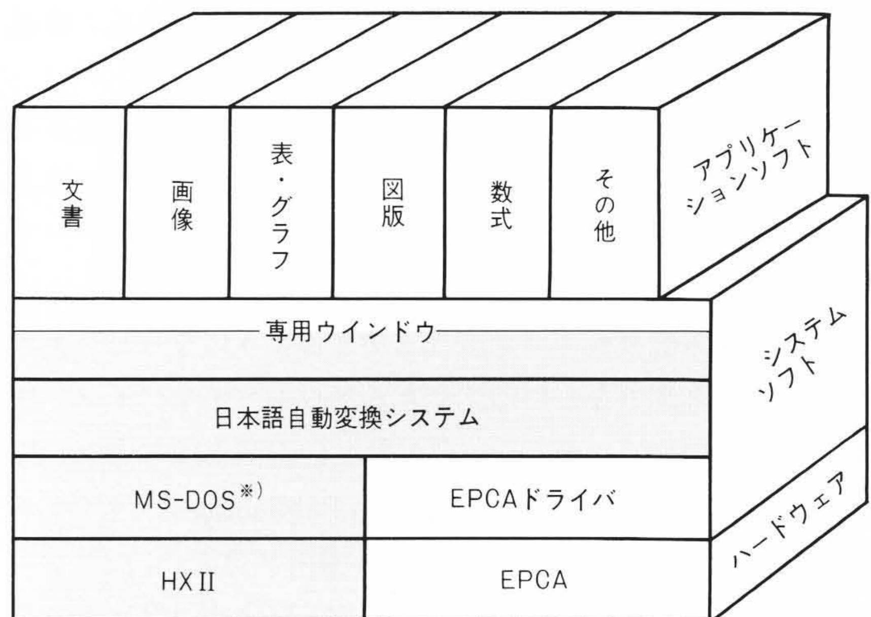
図3 ソフトウェアの構成 B16HX IIの標準OSであるMS-DOS ※) 3.1の上に, 日本語自動変換システム, 専用ウインドウシステムを載せ, その上にHITCAP500のソフトを載せた構造である。
