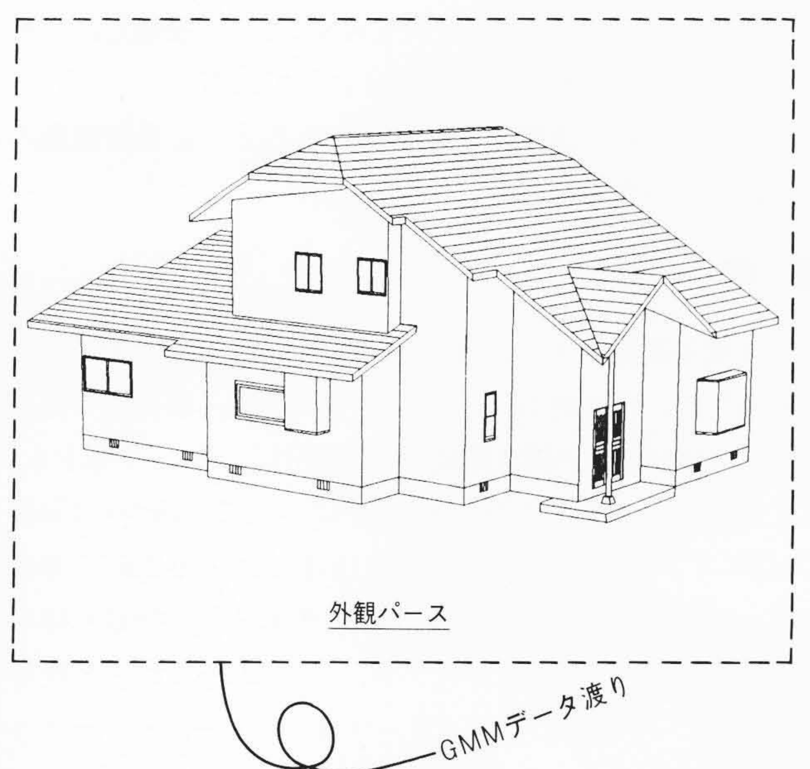
図9 GMMデータ渡し GMM(Graphic Master Mini)側のコンバータ「HITCAPドライバー」を使うことによって、GMMのデータをHITCAP500に取り込むことができる。
