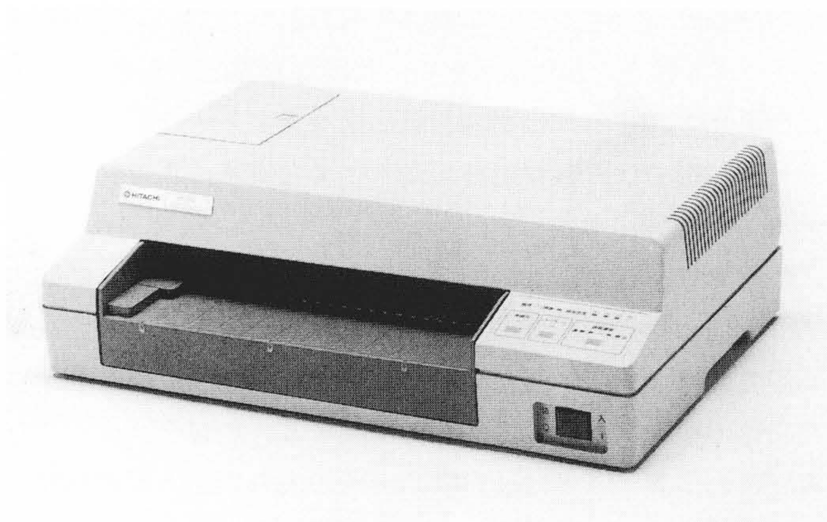
図3 コンパクトイメージリーダー 帳票の読み取りを行う。本コンパクトイメージリーダーには、BELIEVEの画像認識処理をハードウェア化して組み込んである。
