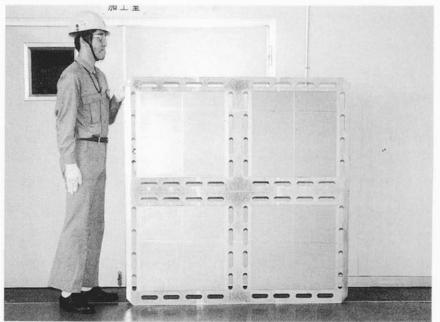
図15 1 m<sup>2</sup>級複合大容量型セパレータ 3,000 cm<sup>2</sup>級単セルが4個同一平面上に配置されるようになっている。
