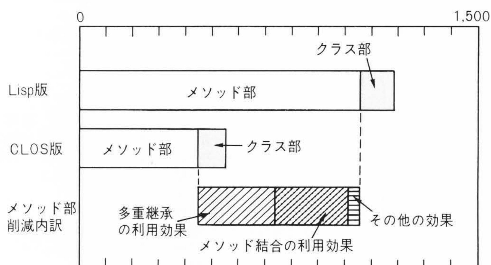
図11 例題によるLispとの記述量比較(単位ステップ) CLOSでは、多重継承とメソッド結合の利用によって、メソッド(手続き)の記述量が半減している。
