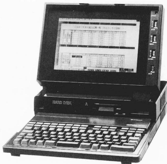
図1 B32LXCの外観 B16LXシリーズのデザインコンセプトを継承している。表示装置は、フィルム位相差式カラー液晶ディスプレイを搭載している。
