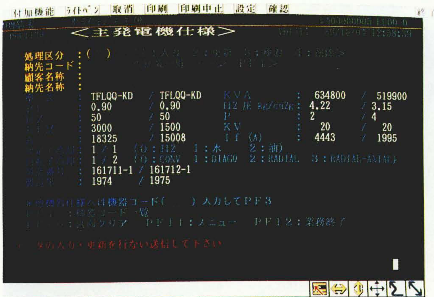
図6 機器仕様，主発電機の画面表示例 この画面で主発電機の基本的な仕様の情報を得ることができる。
