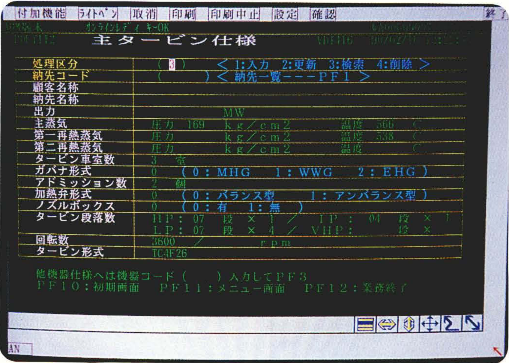
図5 機器仕様、主タービンの画面表示例 この画面で主タービンの基本的な仕様の情報を得ることができる。
