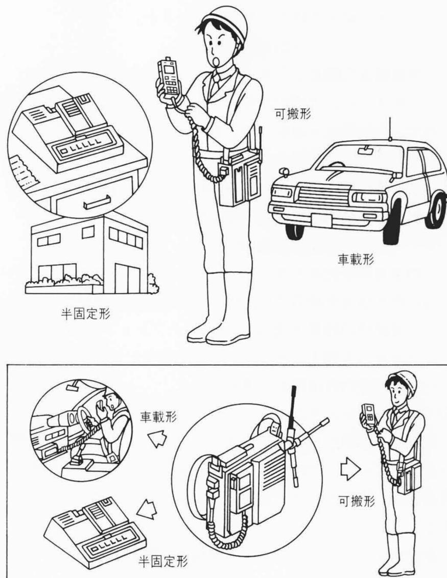
図6 地域防災無線システムの一般局の利用例 ワンタッチ着脱機構(空中線、信号線、電源の一括切り替え)により、利用目的に合わせて可搬形、車載形、半固定形の3とおりに活用できる。
