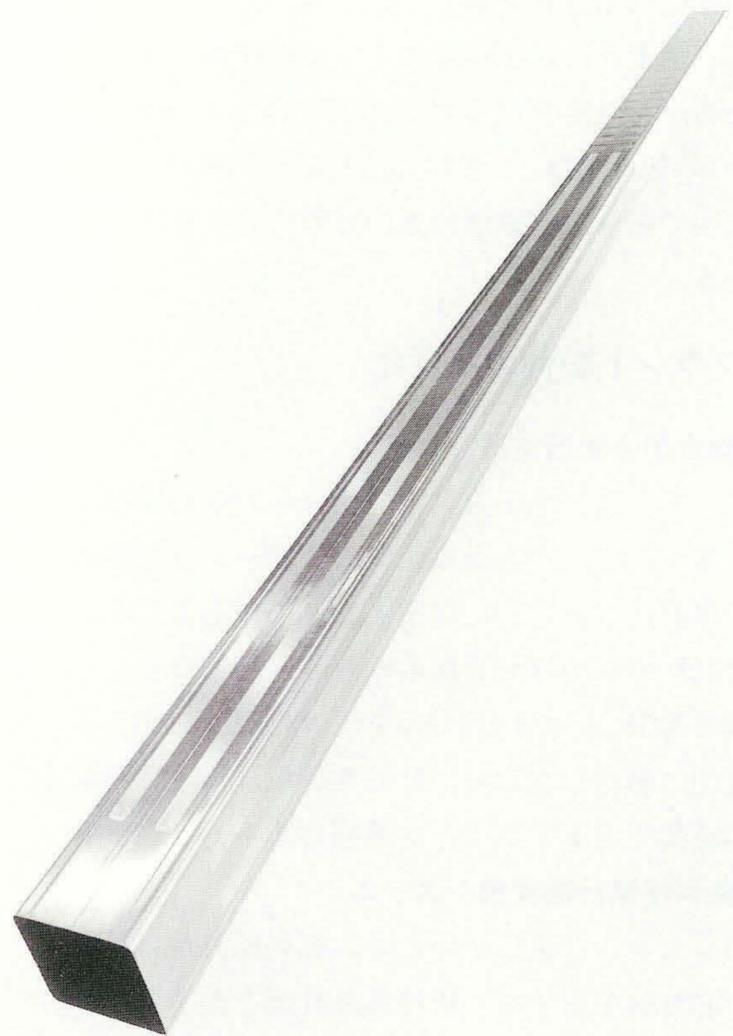
図16 新型チャンネルボックス 新型チャンネルボックスは、コーナ部厚肉, 平たん部薄肉の角筒管構造をしており、使用期間の延長および燃料サイクルコストの改善が図れる。
