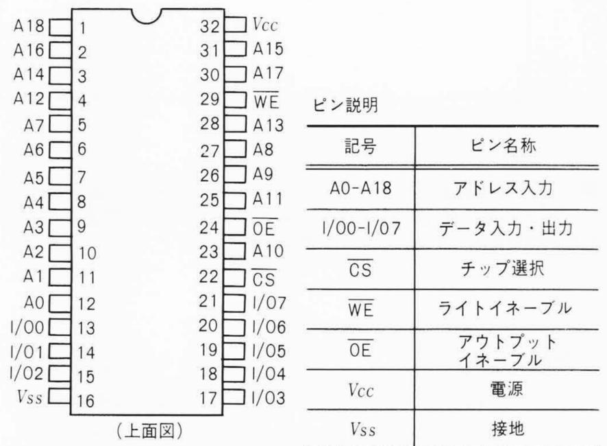
図9 HM628512のピン配置図 ピン配置は、バイトワイド4 MビットSRAMのJEDEC標準配置であり、4 Mビットに擬似SRAMとピン互換性がある。
