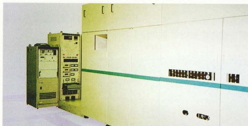
株式会社イオン工学センター納め複合成膜装置(金属注入機)
