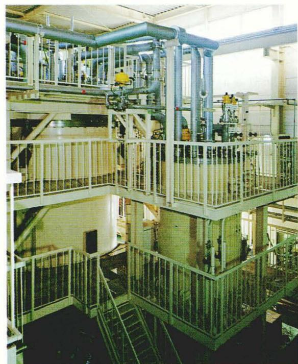
文部省高エネルギー物理学研究所納め6,500 W(4.4 K)ヘリウム冷凍機(右側が追設されたコールドボックス)
