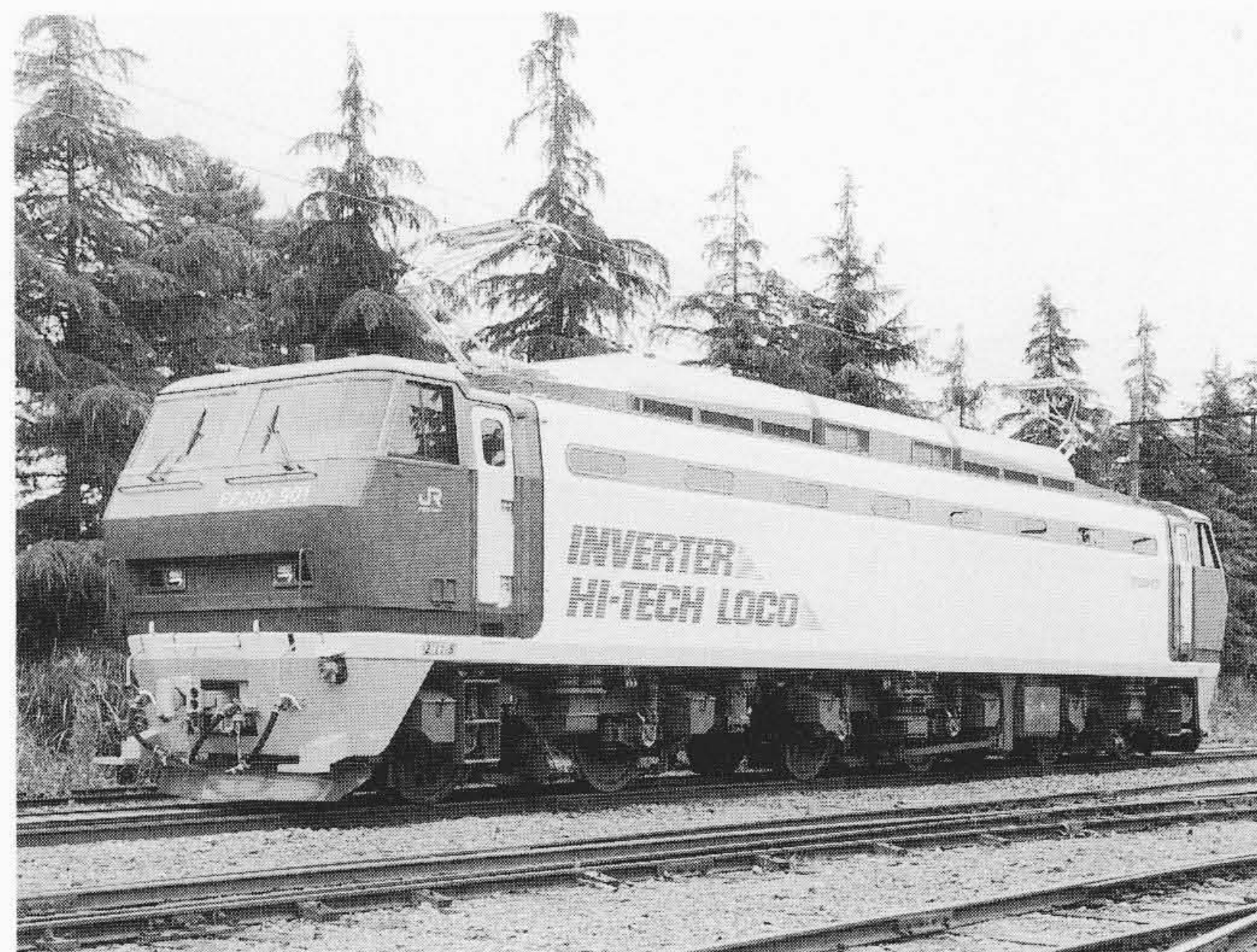
図9 EF200形の外観 運転室周りには彫り込みを設け、カラーリングとともに運転室部分を明確にした特徴のあるデザインとしている。
