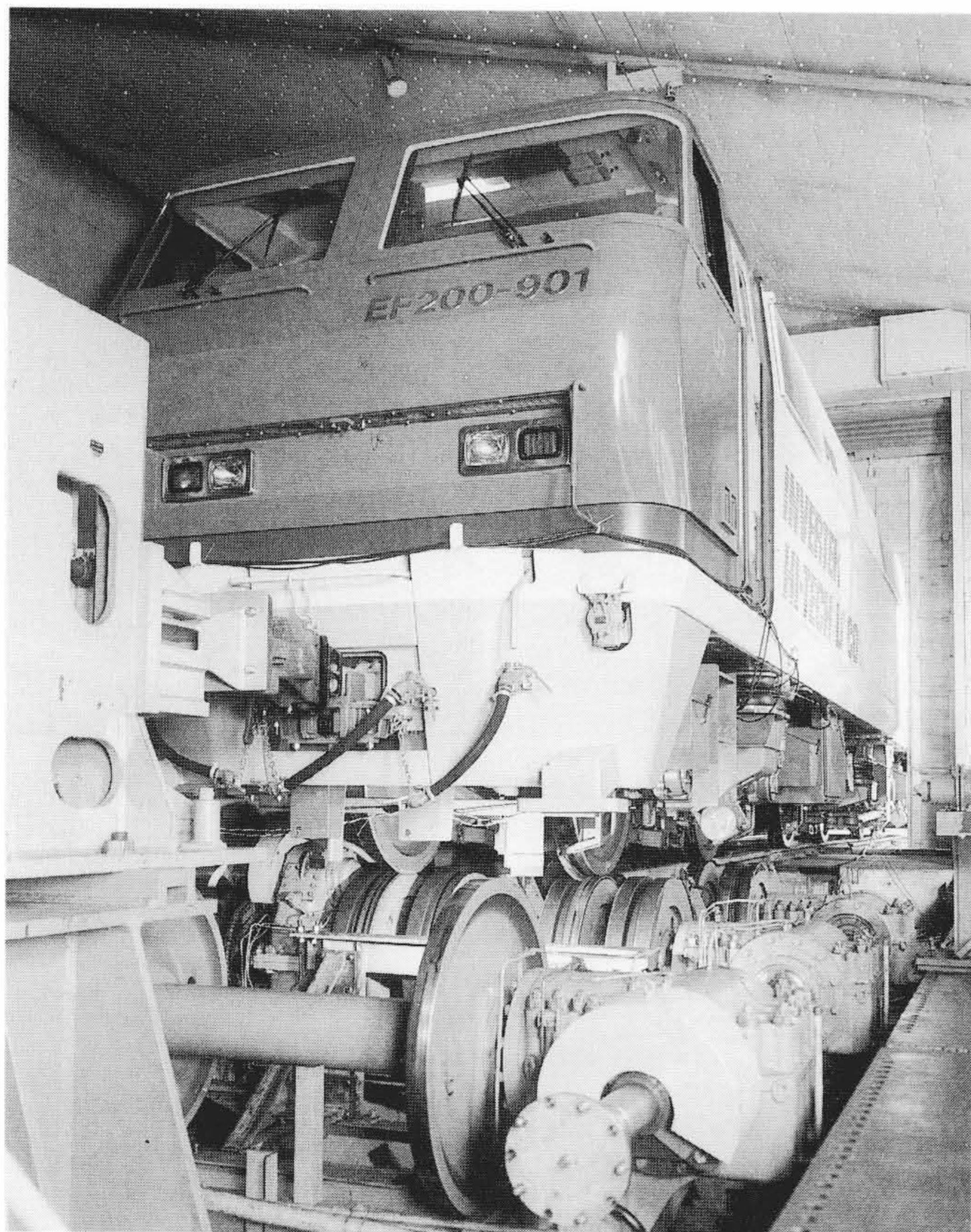
図11 日立製作所工場内の車両総合実験装置による台上走行試験 架線電圧急変試験や台車強制加振による蛇行動安定性試験などを実施している。
