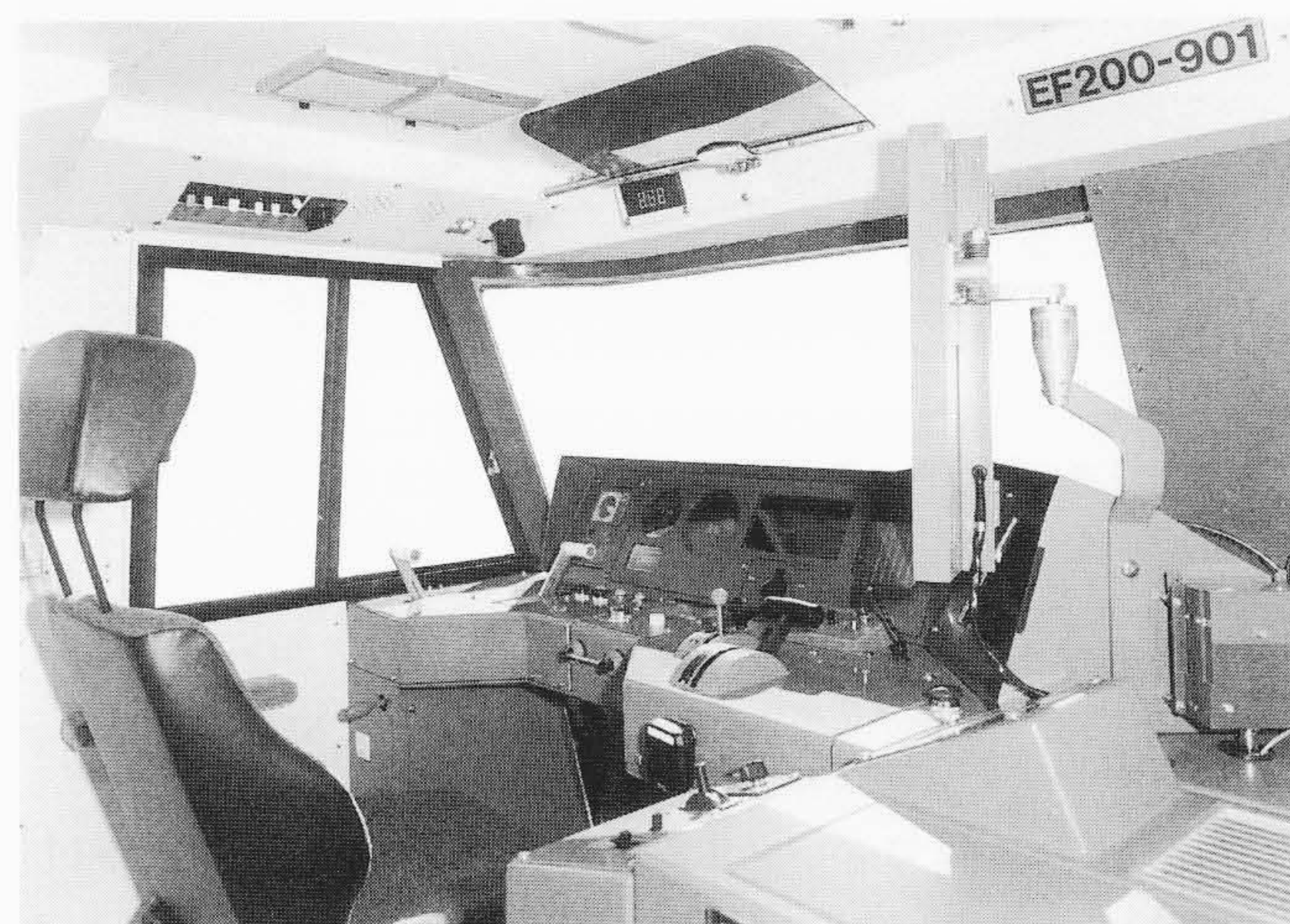
図10 運転室の内観 運転席右手に主幹制御ハンドルを、左手にブレーキ操作ハンドルを配置し、前面パネルには圧力計、速度計、表示灯、主電動機トルク計およびカラー液晶ディスプレイを配置している。
