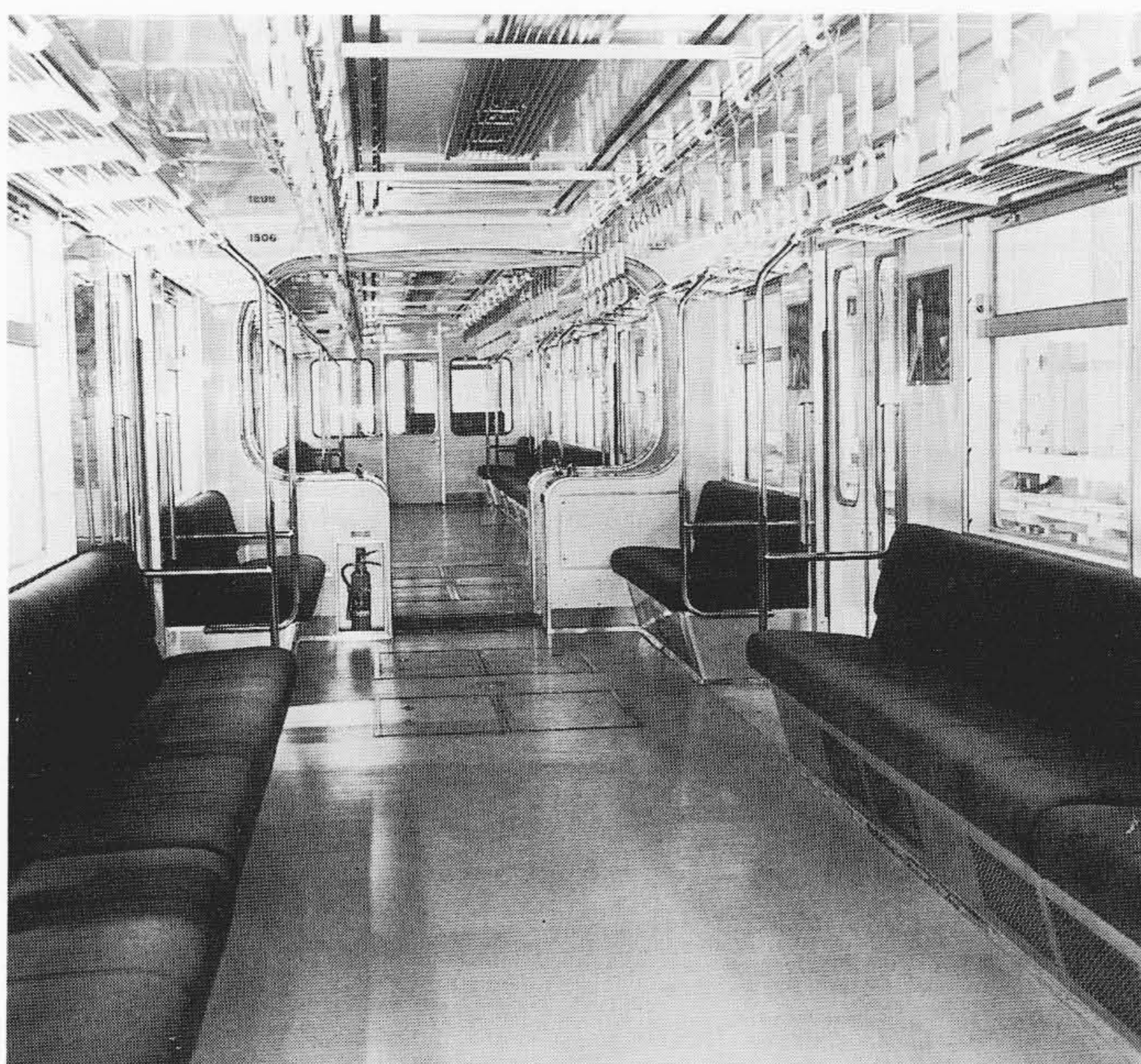
図4 客室内部 床面は全面平面床構造で、座席配置はロングシートとして客室空間を広く確保している。
