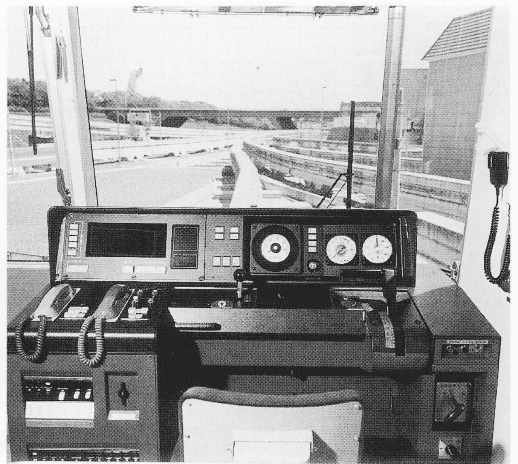
図5 運転室 全面に大形曲面ガラスを採用して視界を拡大し、島式ホームでのワンマン運転に対応するため、運転席は右側に配置してある。
