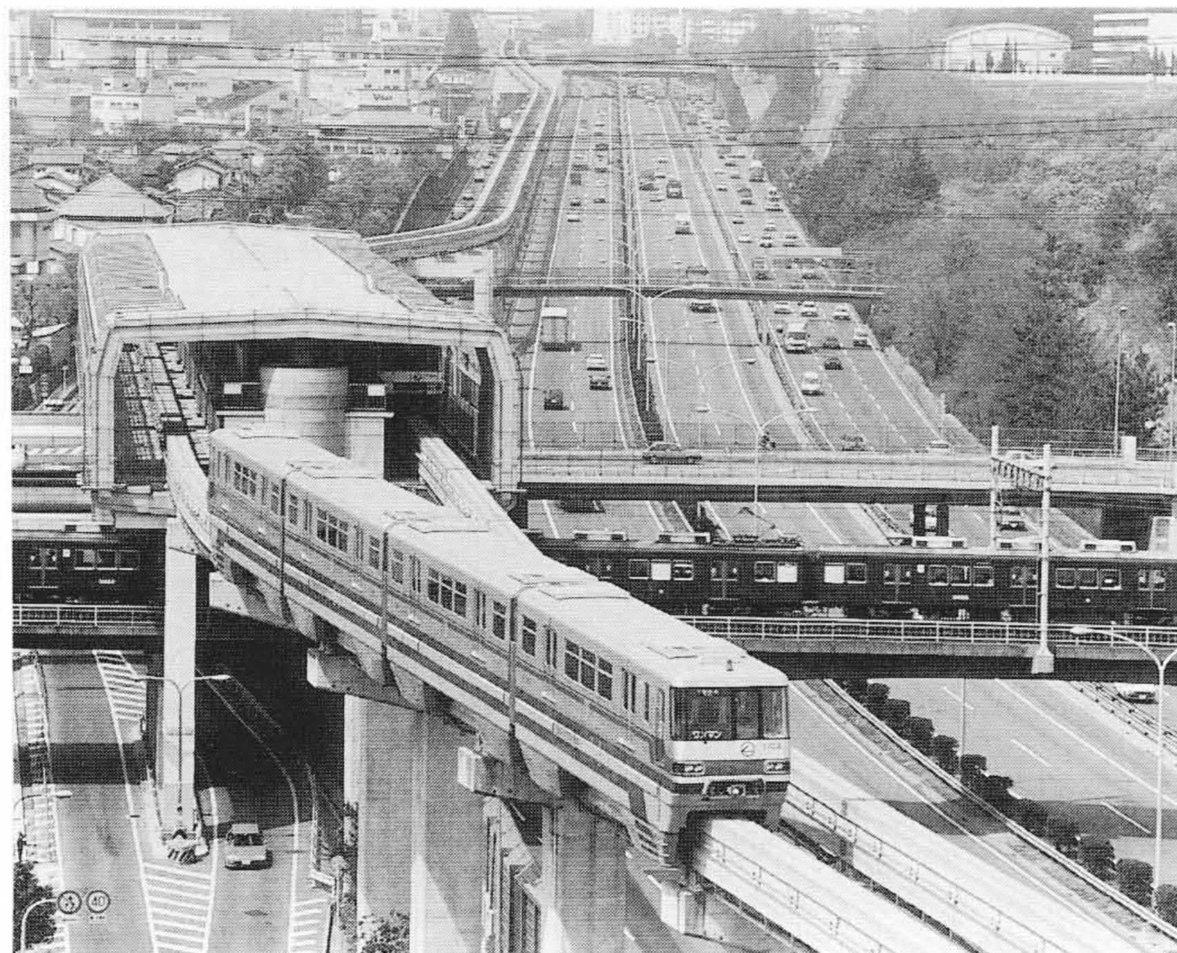
図2 車両外観 アルミ無塗装仕上げの車体に、大阪府のシンボルカラーであるウルトラマリンブルーを配し、スピード感あふれるデザインとなっている。
