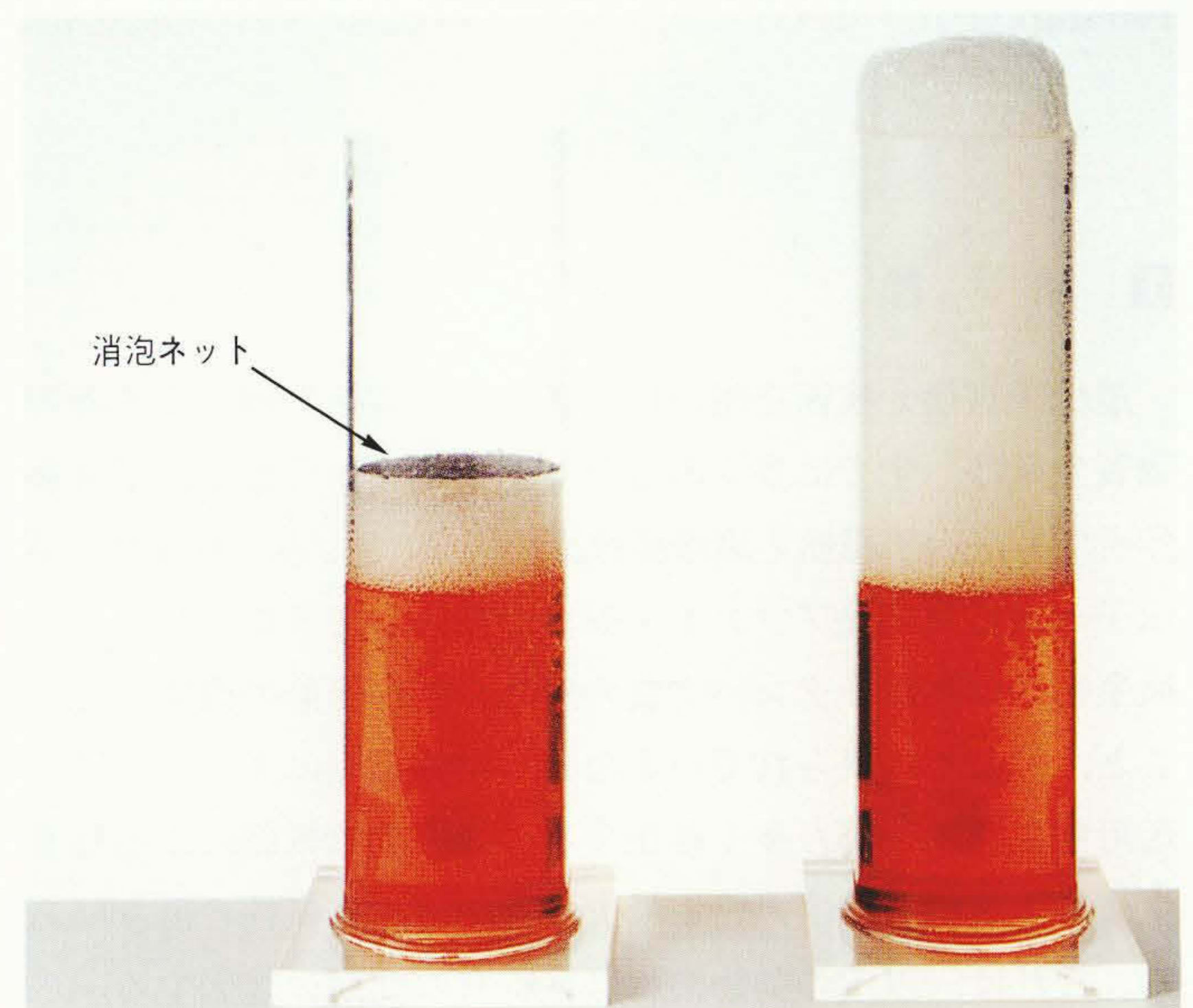
図1 消泡ネットの効果 液中通気によって発生した泡は消泡ネット(左側)によって破壊され、容器外へのあふれ出しを防止できる。
