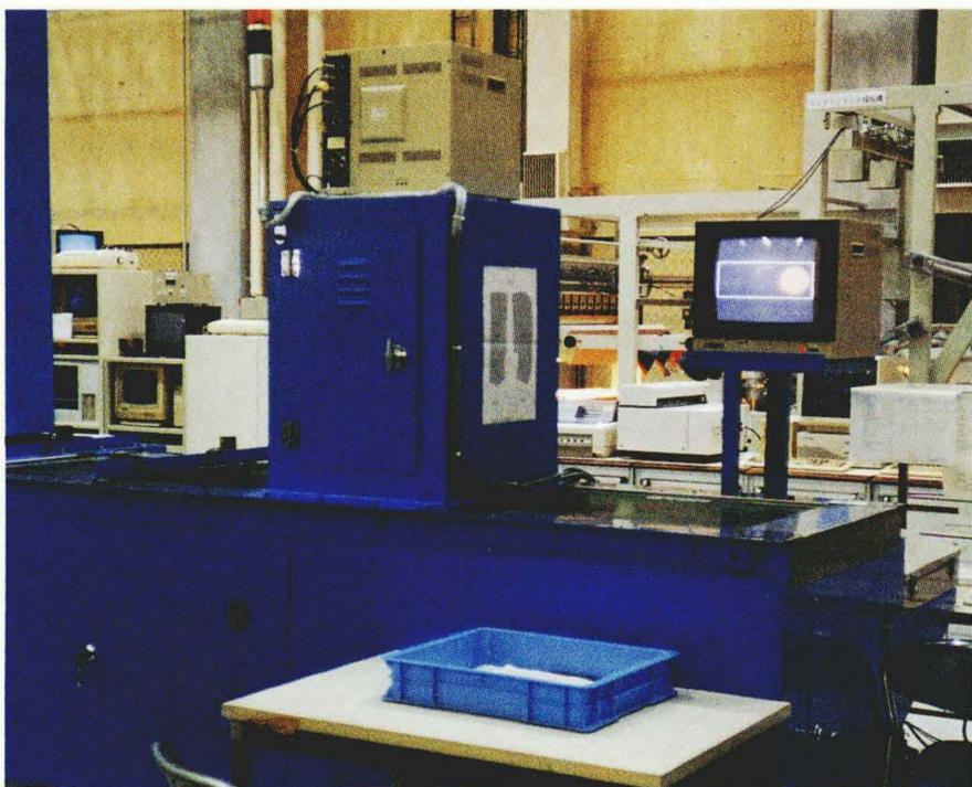
図9 付与情報認識装置の外観 付与情報認識装置の外観を示す。パーツを右方から投入し、中央部の暗室内でパーツID(Identification)を読み取り、パーツを表裏反転し左方から送出する。
