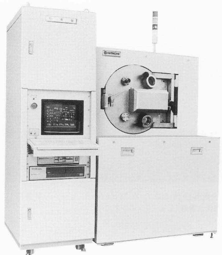
図4 イオンビームミリング装置(形式IML-350) 均一, 低発散ビームでワンタッチ開放のバケツ形イオン源を使用し, 加工性, 保守性の良い装置となっている。
