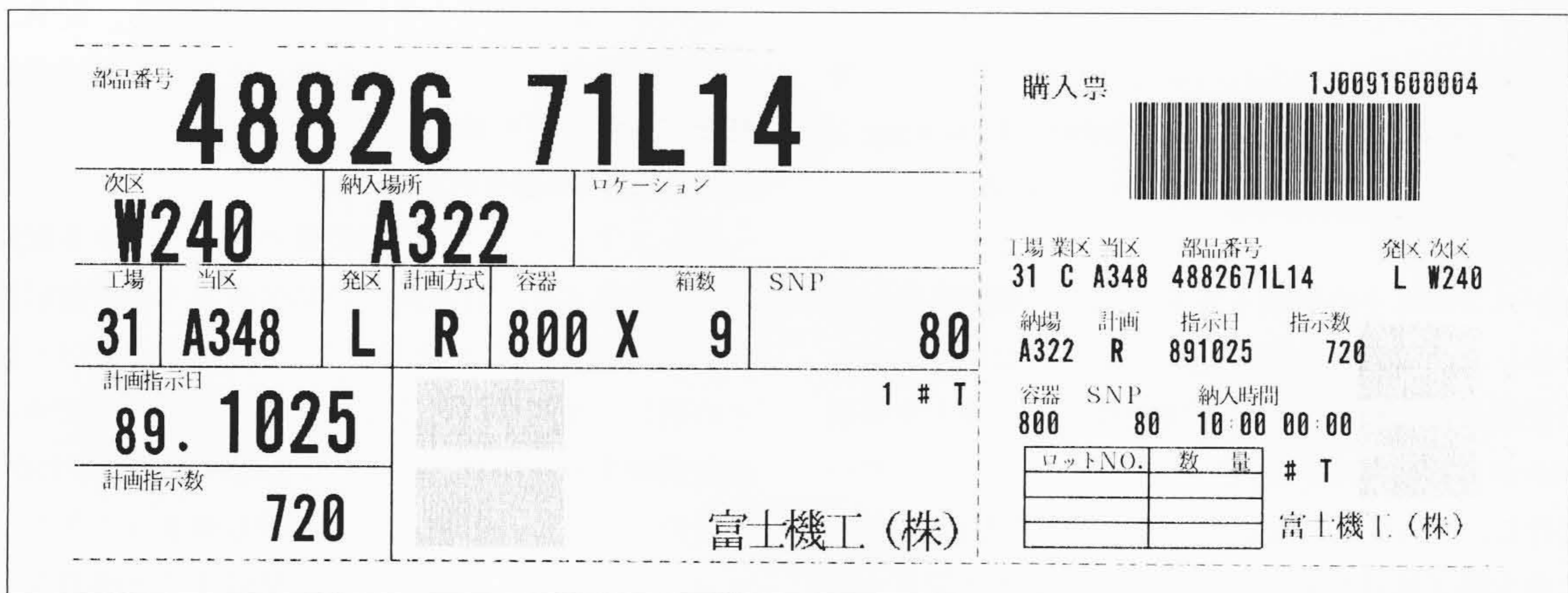
図8 バーコードラベル 現品票と一体となったバーコードラベルを示す。
