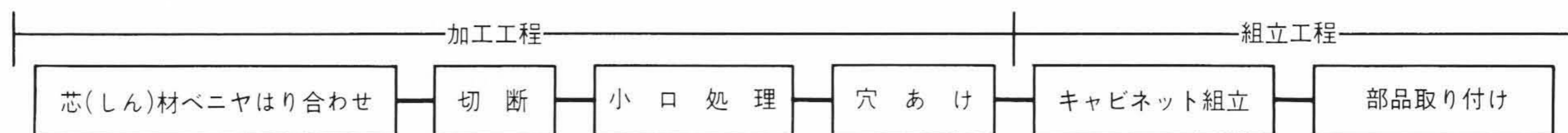
図5 システムキッチン生産工程 生産工程の手順を示す。
