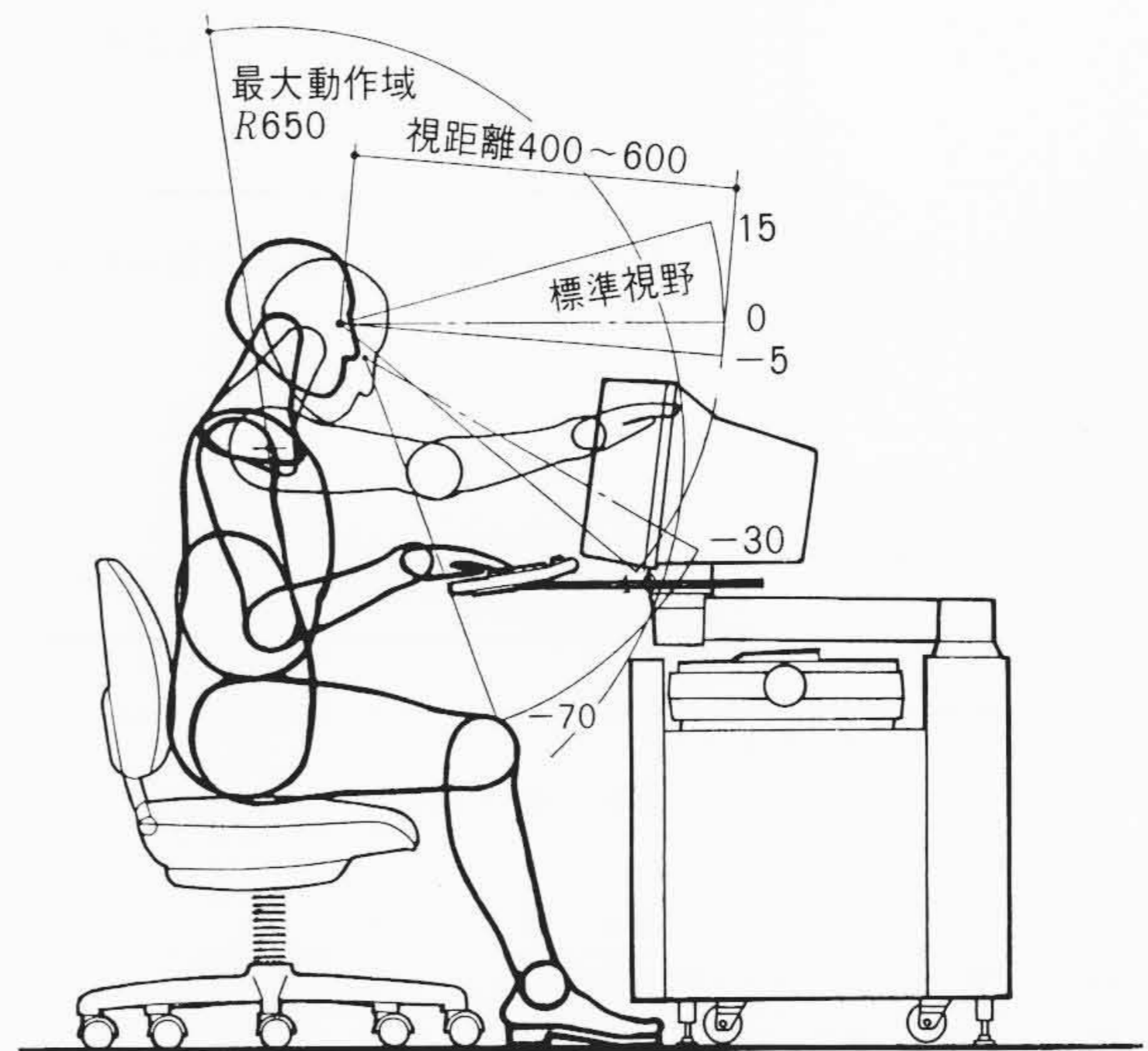
図5 操作ユニットの人間工学デザイン キーボード・CRTディスプレイを可動式フリーアームに取り付けることによって，立ち操作，座り操作いずれにも対応できる。
