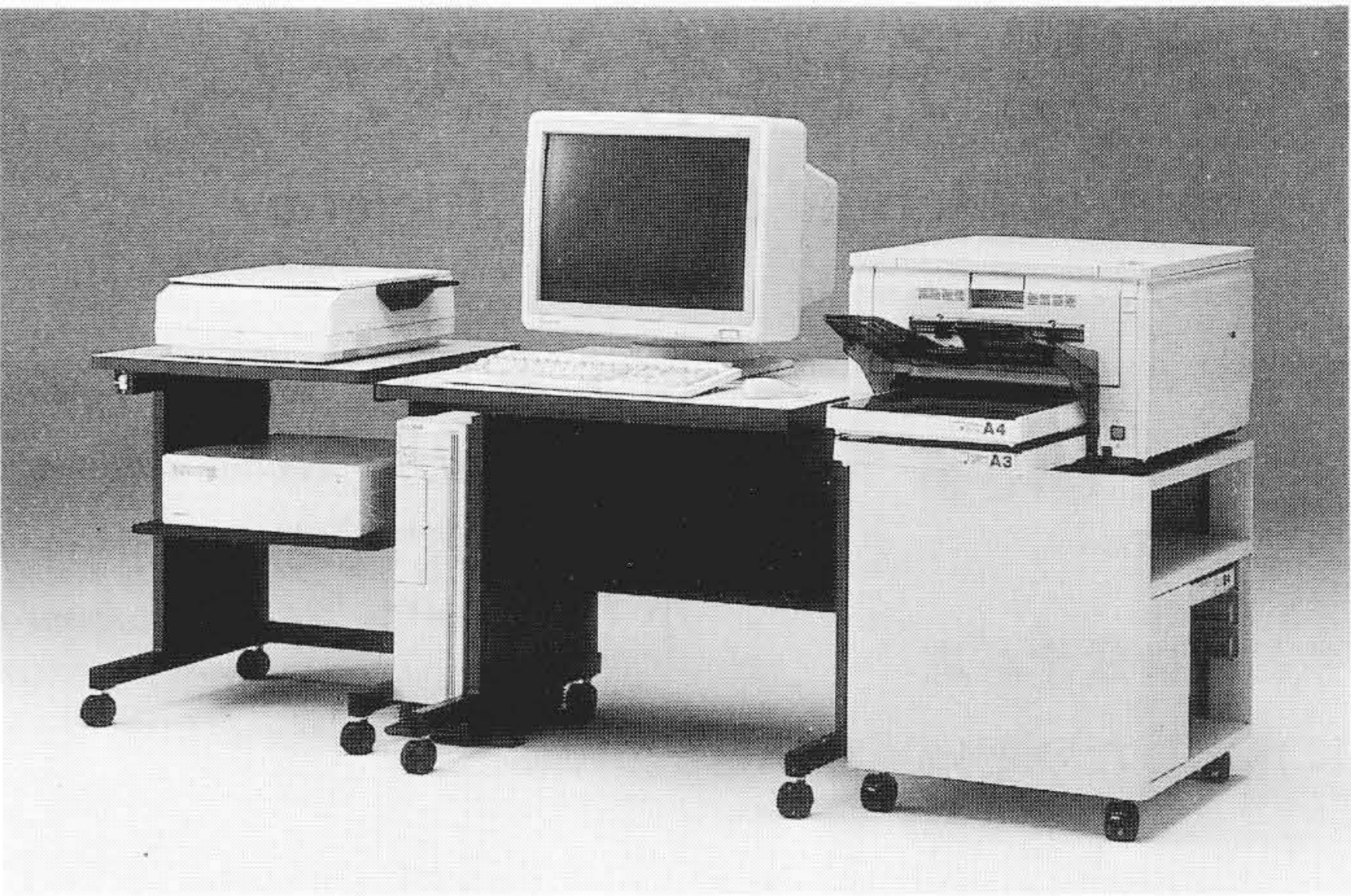
図1 HITCAP600Mのシステム外観 21インチカラーディスプレイおよびA3レーザビームプリンタを組み合わせた例を示す。
