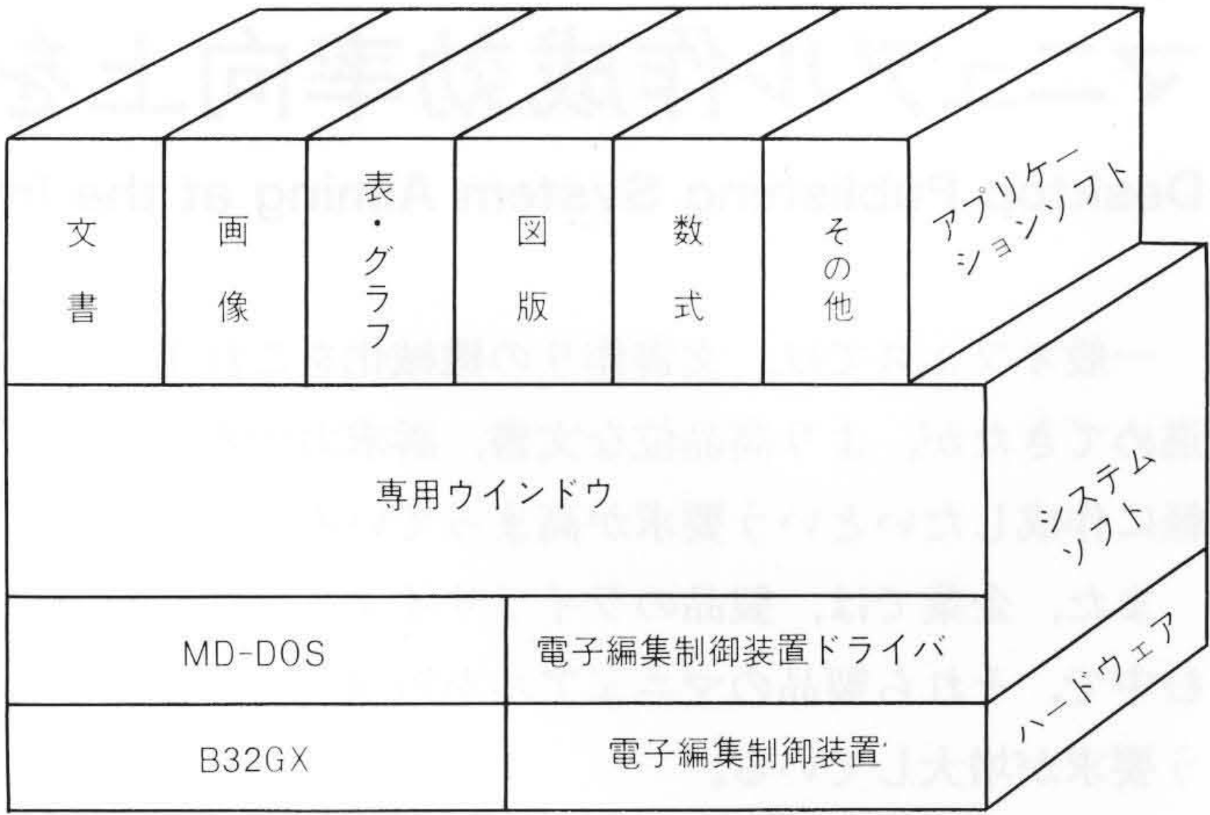
図3 ソフトウェアの構成 MS-DOSの上に専用ウインドウシステムを載せ、HITCAP600Mのソフトウェアを載せた構造である。
