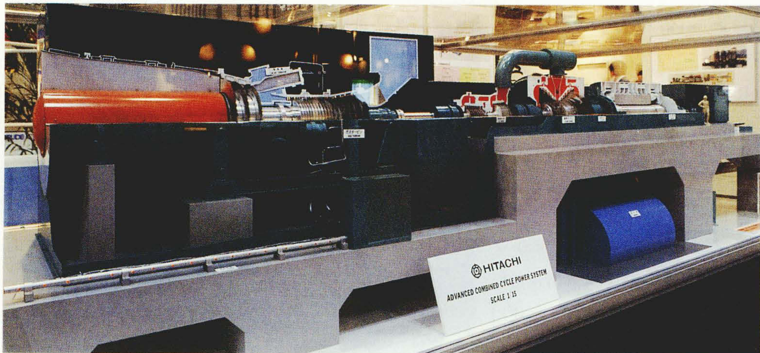
大容量ガスタービンを用いたわが国初の排熱回収形コンバインドサイクル発電プラント(模型)
