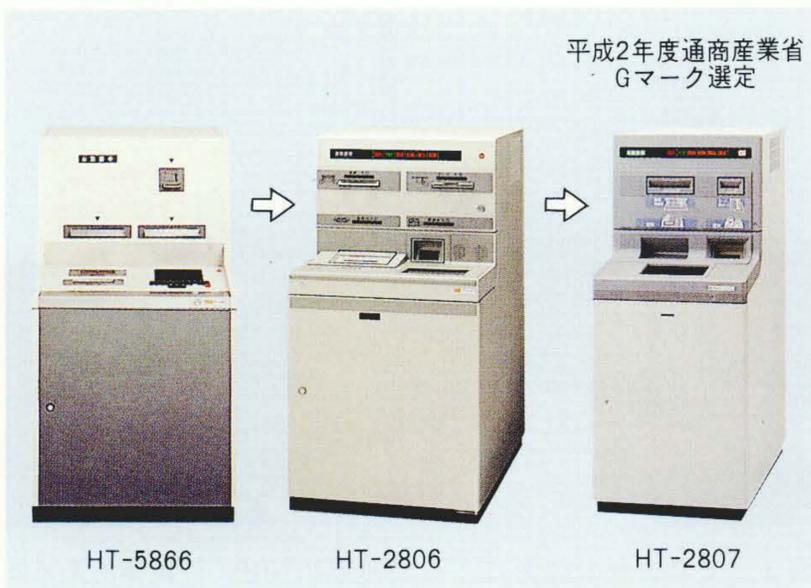
図1 金融自動機デザインの変遷 媒体出入り口と操作画面の位置の集中化の変遷を示す。
