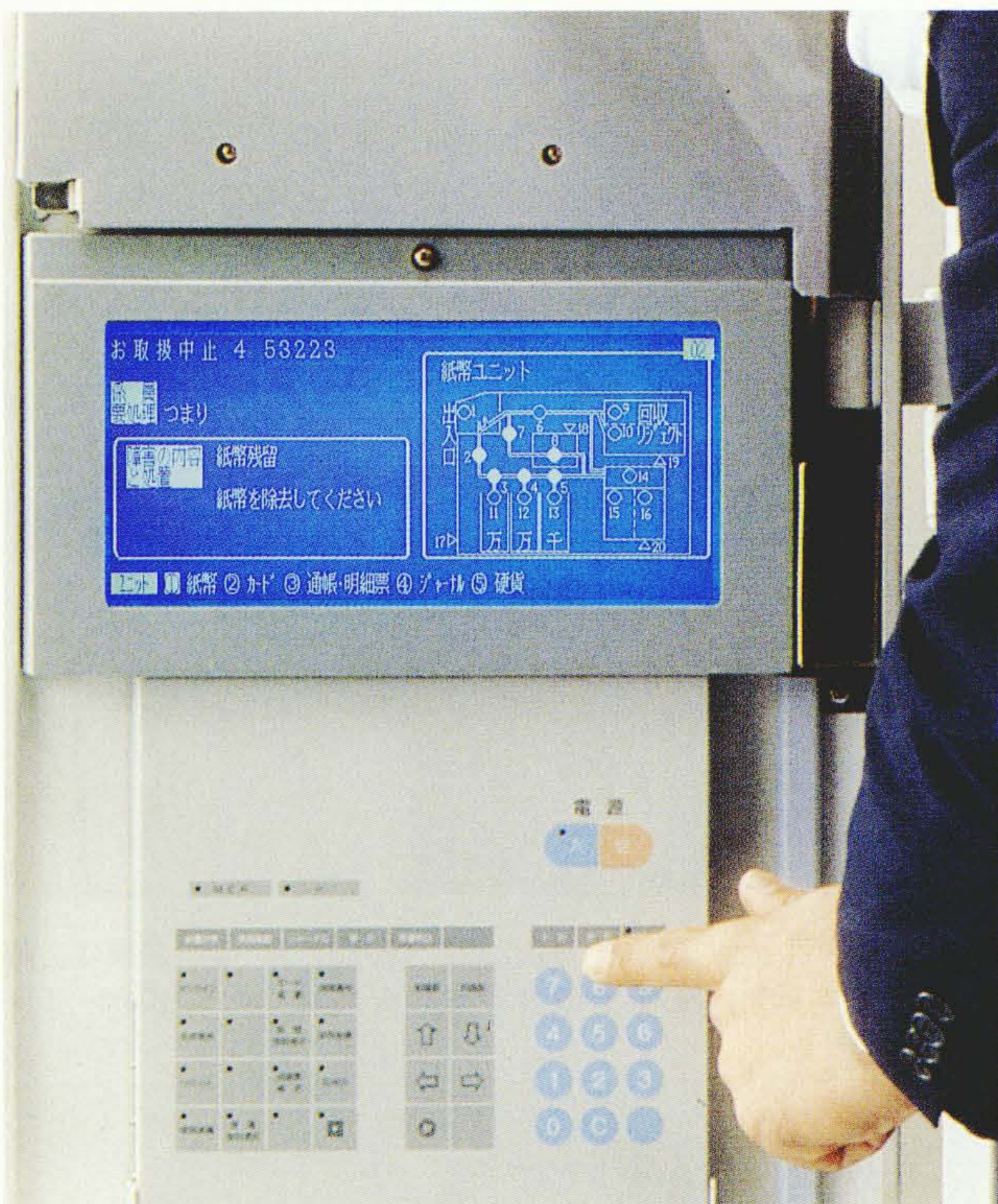
図5 係員用液晶ディスプレイ 装置後扉のオペレーターパネルに液晶ディスプレイを採用し、文字とイラストとによるガイダンスを可能にした。
