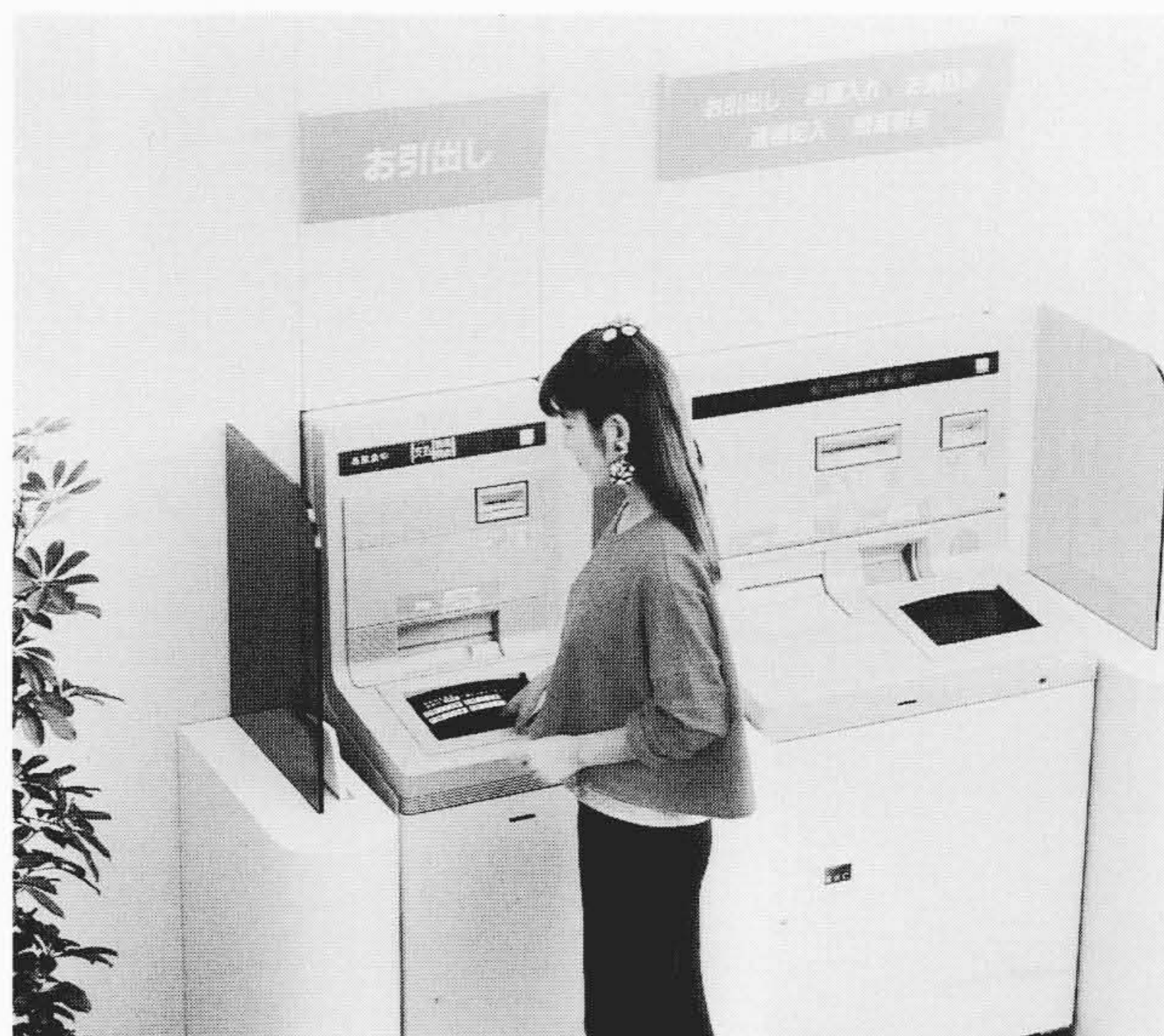
図7 現金自動支払装置“HT-2802”(左側) この装置は、幅45cmの中に紙幣・明細票の大容量化を実現したCD(Cash Dispenser)である。
