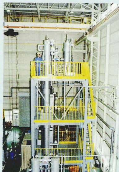
重力落下式非常用炉心冷却系試験装置
