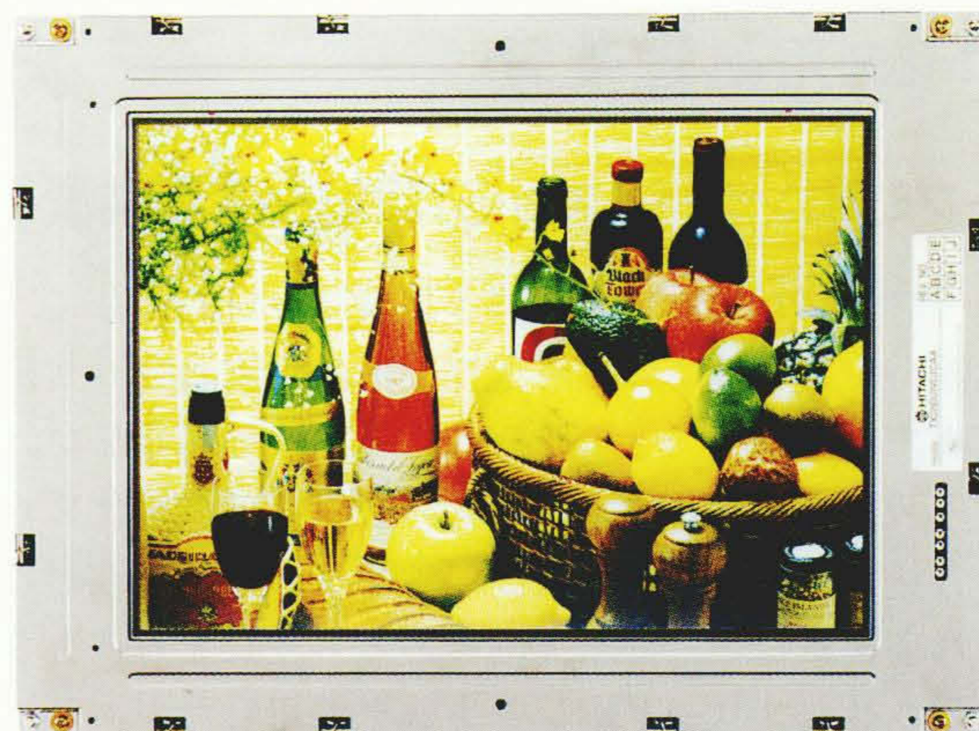
4,096色表示11型高精細TFT液晶ディスプレイモジュール
