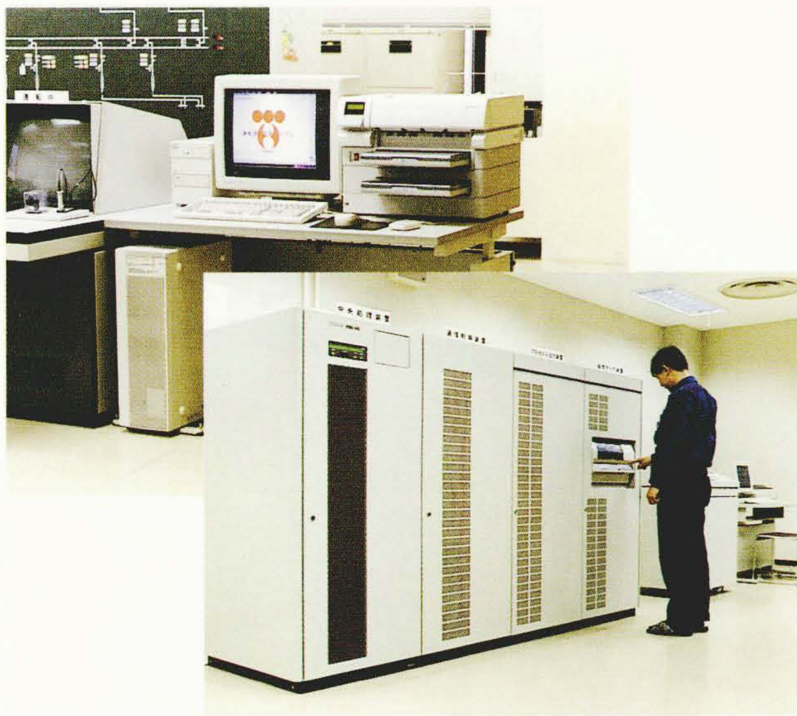
制御室のワークステーションと計算機室の計算機(HIDIC V90/45)キュービクル構成
