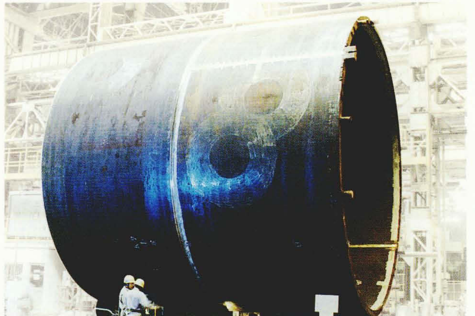
工場製作中の7号機用原子炉圧力容器胴体
