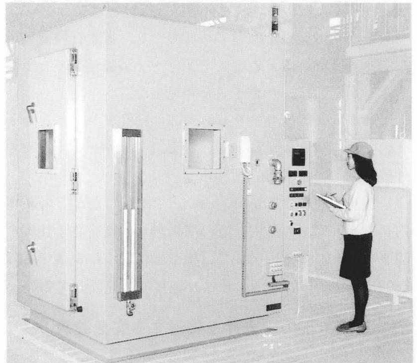
図9 気圧シミュレータ装置 エレベーター昇降特性に応じて、エレベーターのかご内の気圧が変化する高低差気圧シミュレータ(最大高低差800 m)装置を示す。
