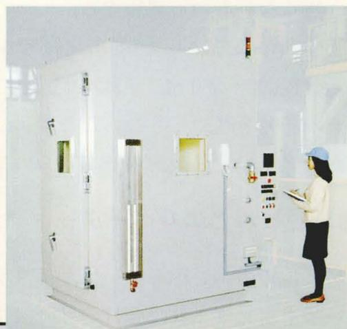
気圧変化シミュレータ装置
