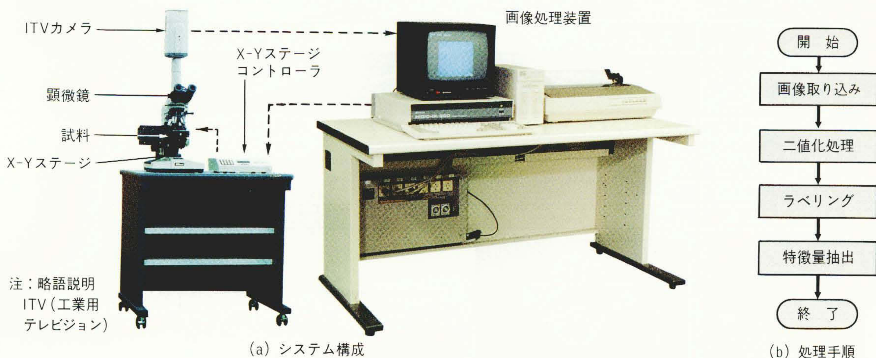
図3 システムの構成と画像処理手順 顕微鏡を中心とする撮像系と、画像処理専用のVLSIを内蔵した高速画像処理装置で構成している。
