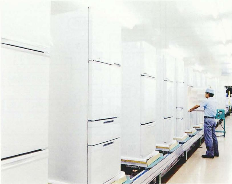
図3 冷蔵庫の混流ライン 冷蔵庫の混流生産ラインを構築して、フレキシブルでかつ高効率な生産システムを実現した。
