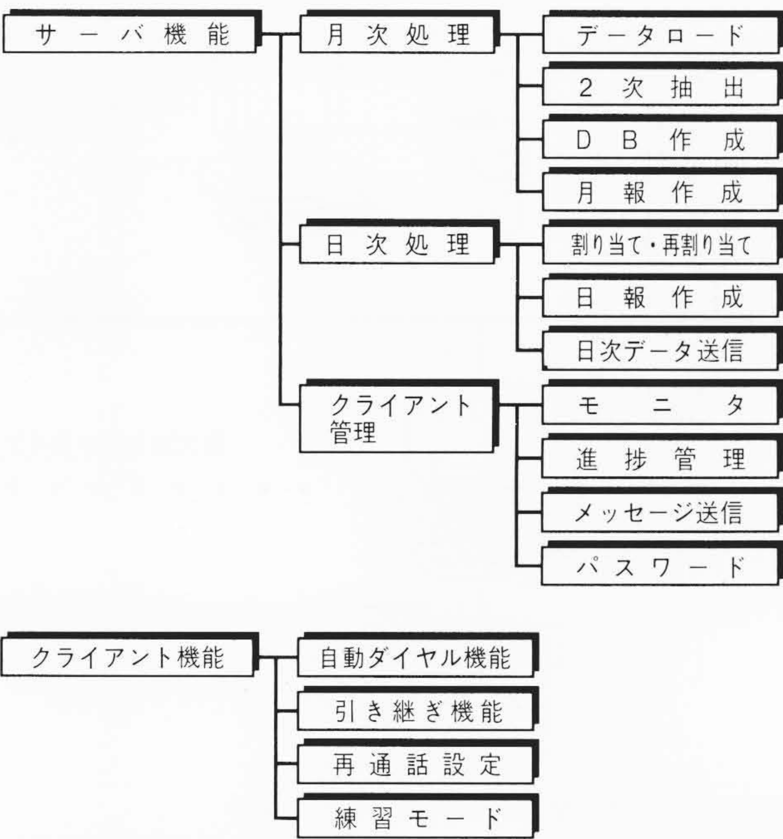
図2 システムの機能概要 このシステムの機能は、サーバ機能、クライアント機能に分けられる。
