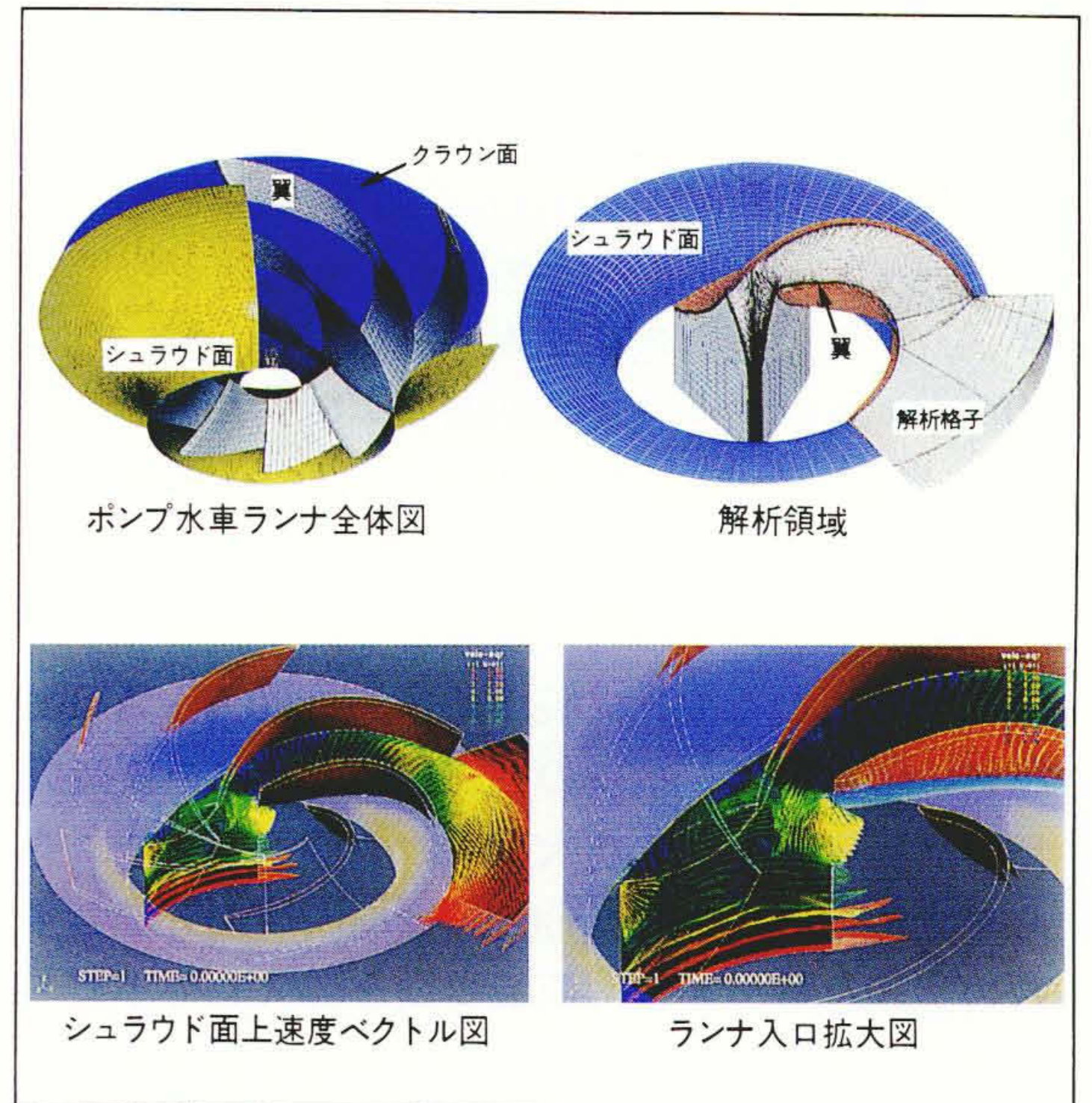
ポンプ水車ランナ内部の三次元流れ解析例
