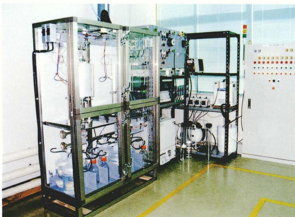
触媒方式によるフロン分解処理試験装置
