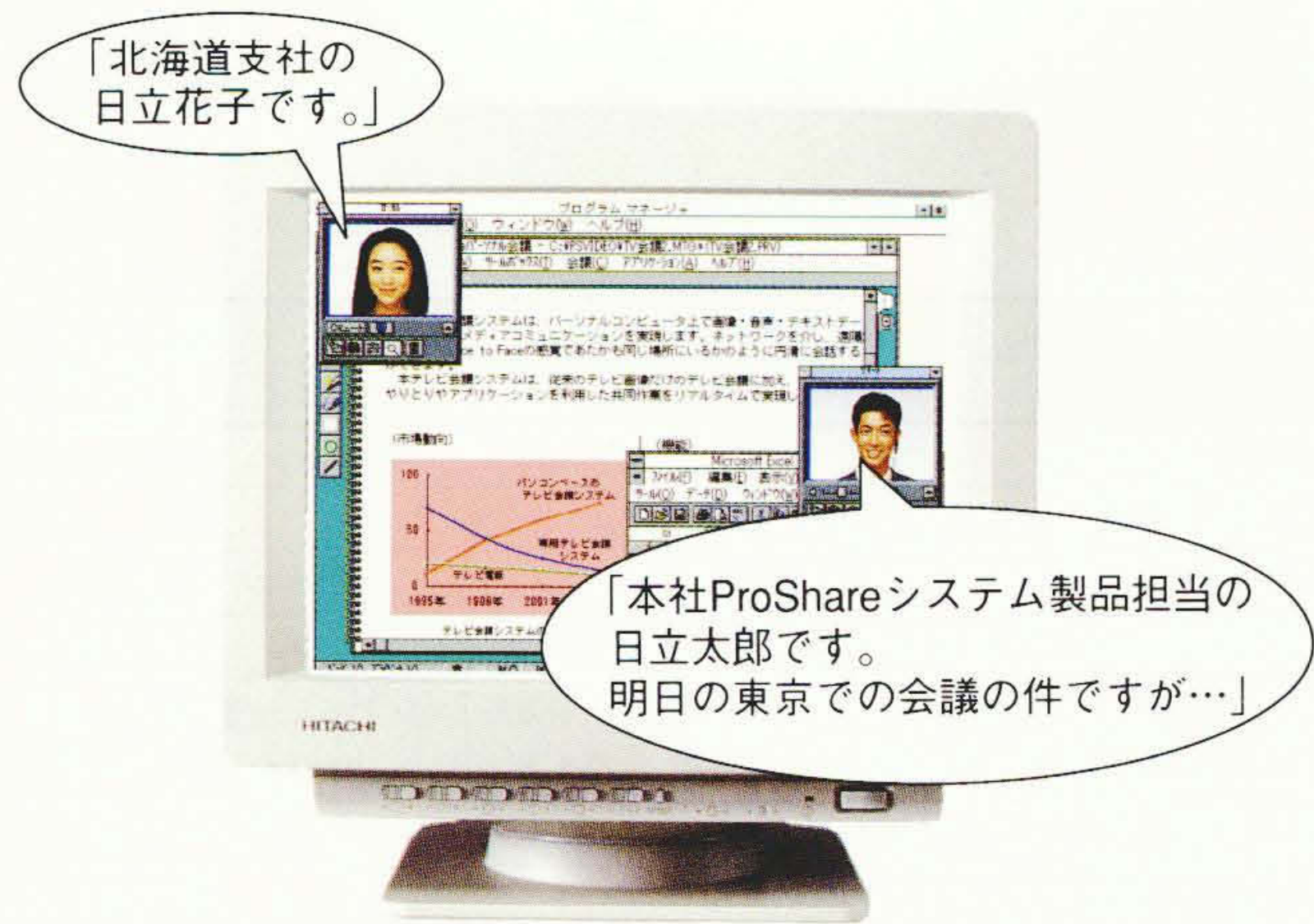
図2 ビデオ会議システム ISDN(Integrated Services Digital Network)またはLANで接続されたパソコン間で画面, 映像, 音声のリアルタイムなコミュニケーションができる。
