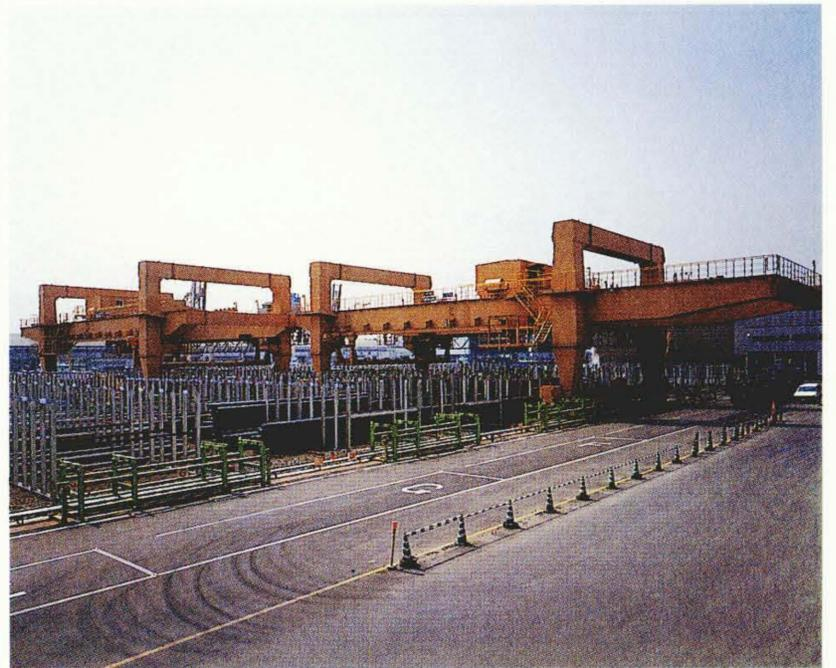
図3 ビレットヤード自動化システムの外観
