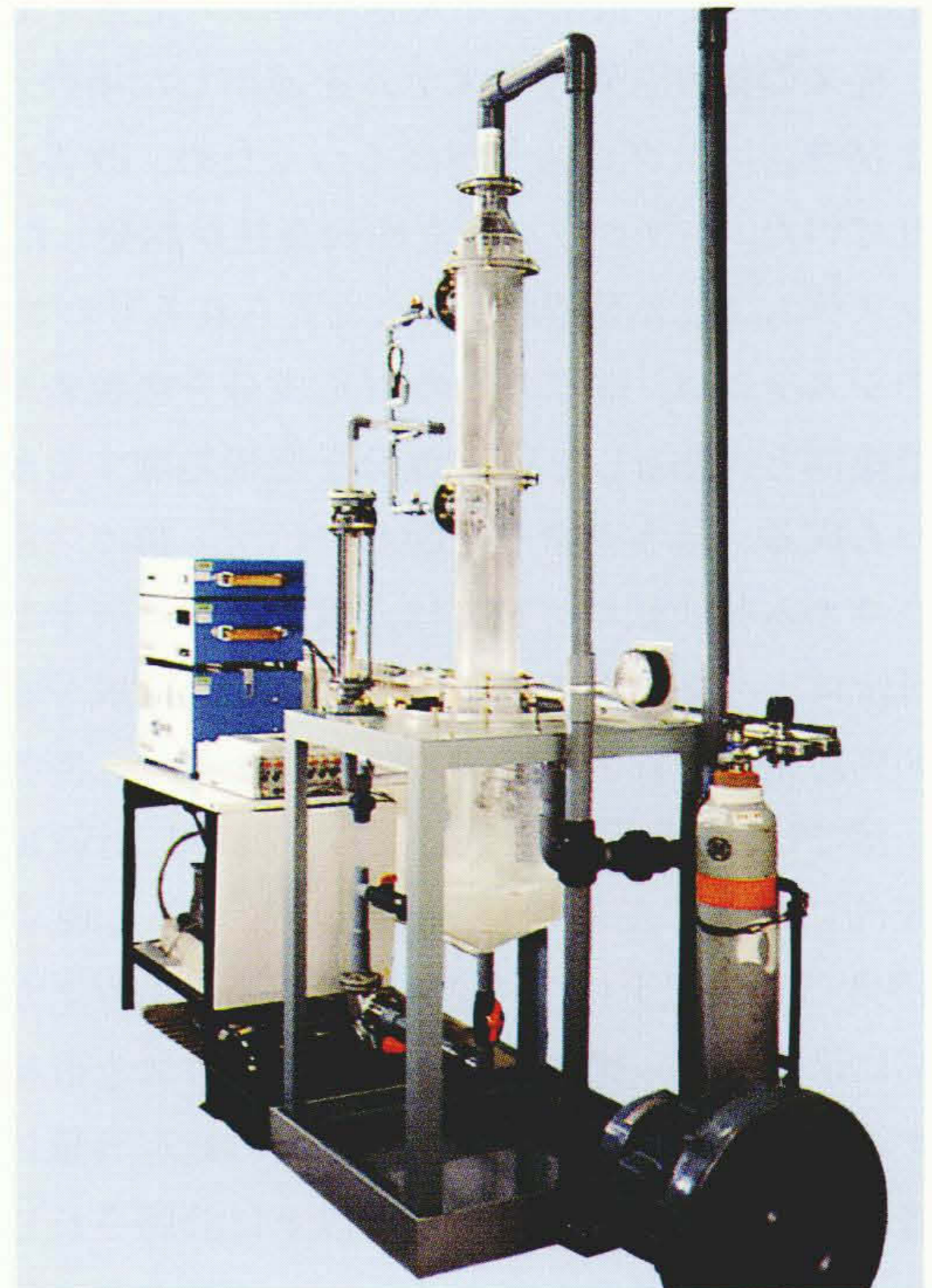
図4 NOx吸収除去装置
