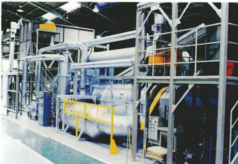
図5 廃棄物固形燃料化システム実証プラント
