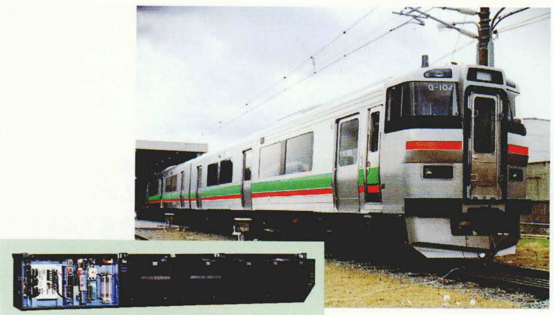
731系交流電車(右)とIGBTを使用した3レベルPWM主変換装置(左下)
