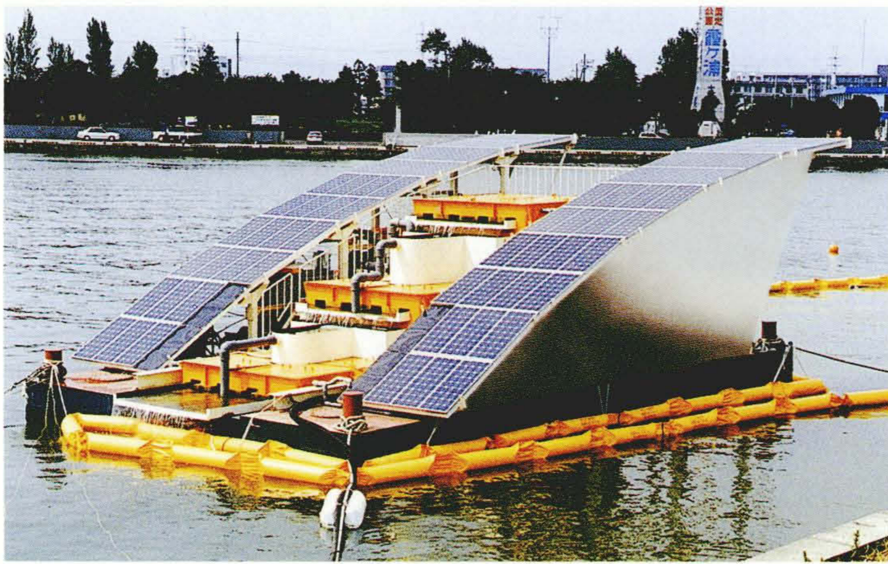
霞ヶ浦における流動床ろ過システムの湖水浄化実験
