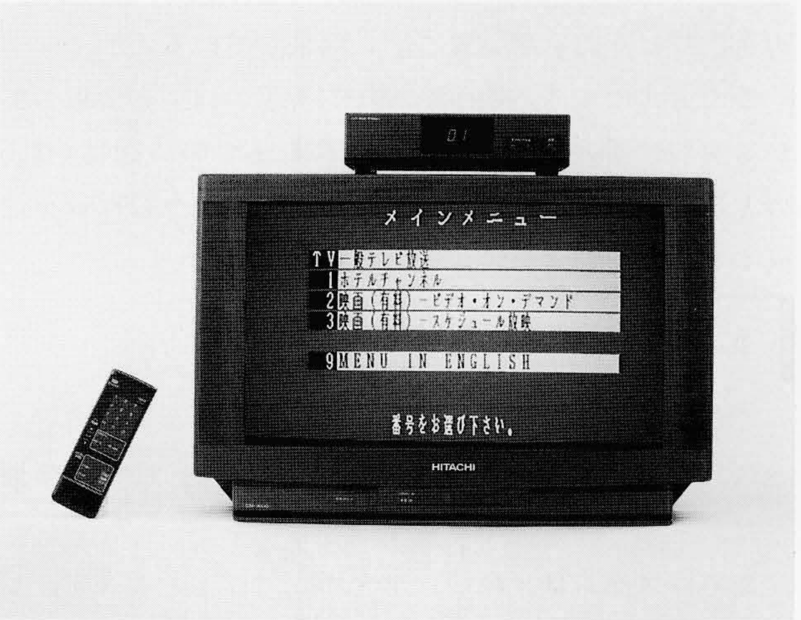
図2 客室受信用端末“BK-1050C”と専用リモコン(ワイドテレビ上に端末を設置した例で、画面はメインメニューの例)
