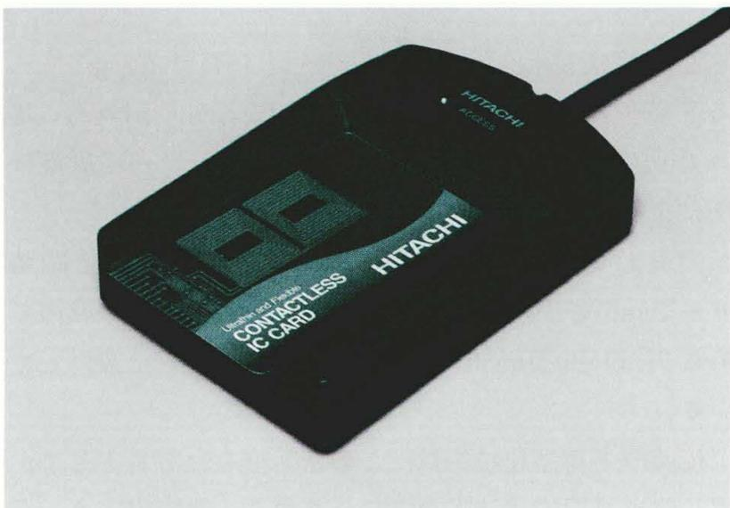
図1 非接触ICカードとリーダ・ライタ
