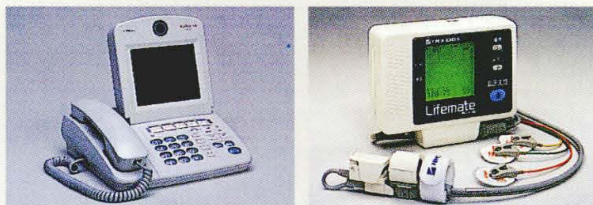
(a) テレビ電話 カメラ、液晶モニタ、ハンドセットを一体化したテレビ電話。携帯型救急モニタと組み合わせてセンター側と通信ができる。 (b) 測定器(携帯型救急モニタ) *日本光電ウエルネス株式会社の製品を使用
