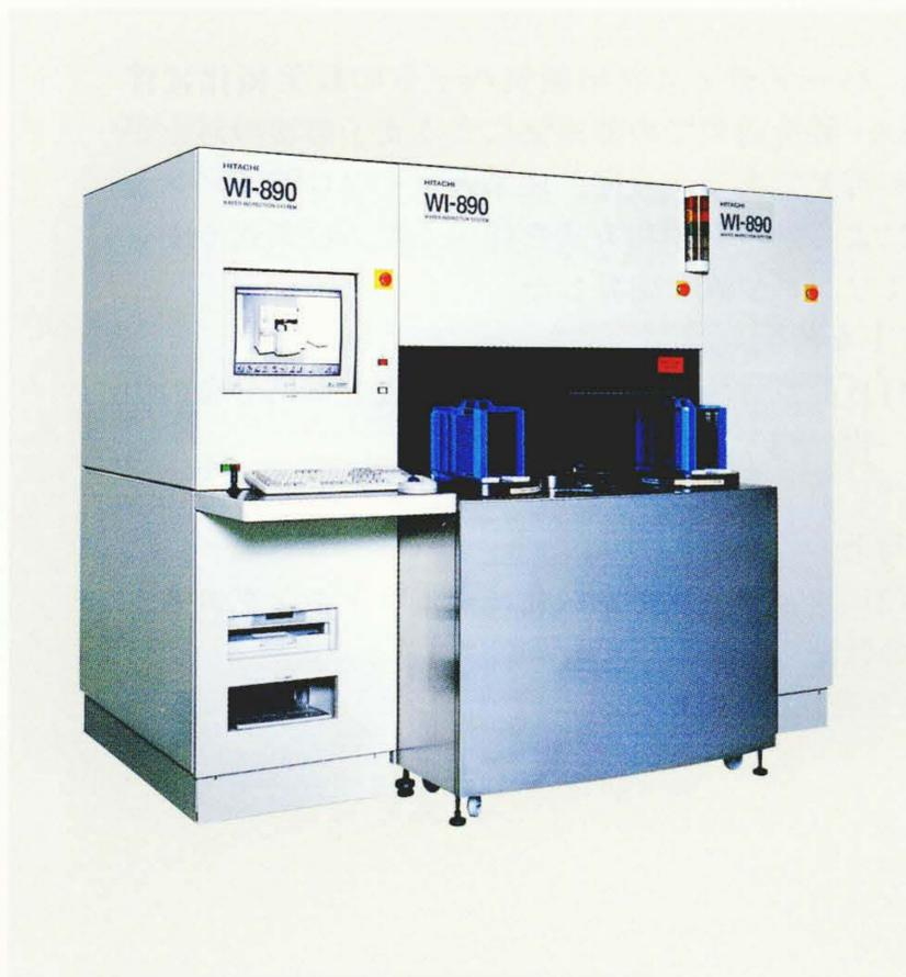
光学式ウェーハ欠陥検査装置「Iシリーズ」
