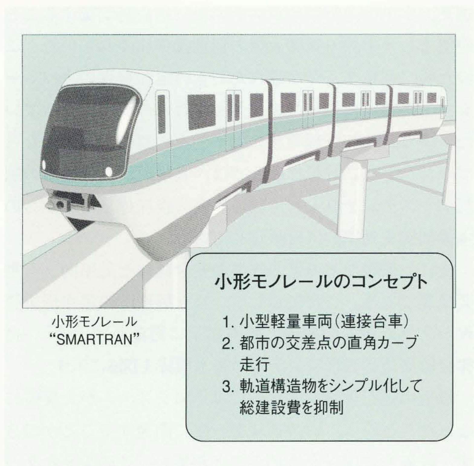
図4 小形モノレール“SMARTRAN”の外観と設計コンセプト 日立製作所は、中小都市の交通混雑緩和のためのソリューションとして、総建設費を抑えた小形モノレール“SMARTRAN”を提案している。
