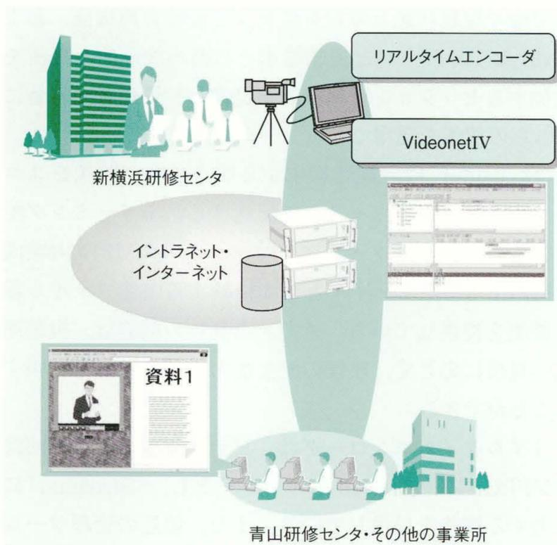
図5 日立製作所の総合教育センターにおける“Videonet IV”の利用の仕組み
