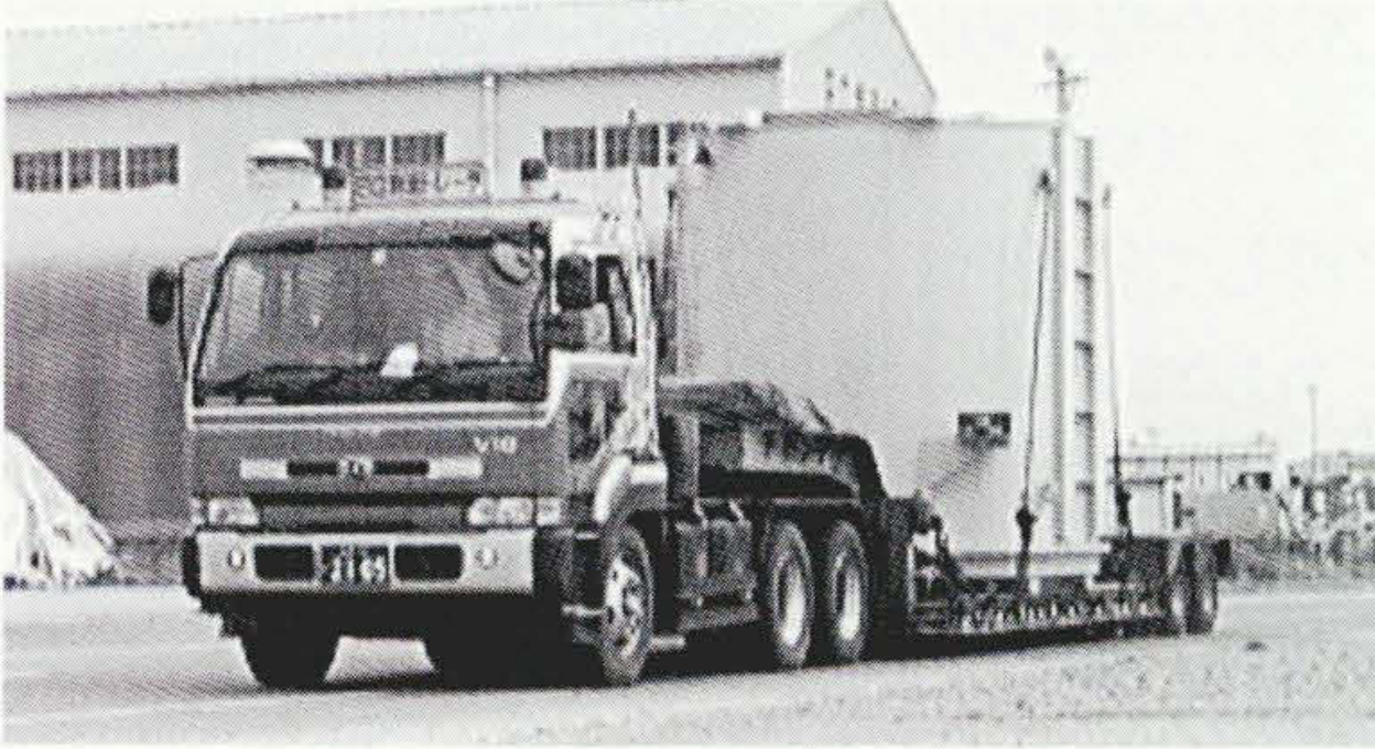
図4 試作変圧器の輸送試験の様子 輸送試験前後では、輸送の影響を確認するために、電氣的特性試験を実施する。
